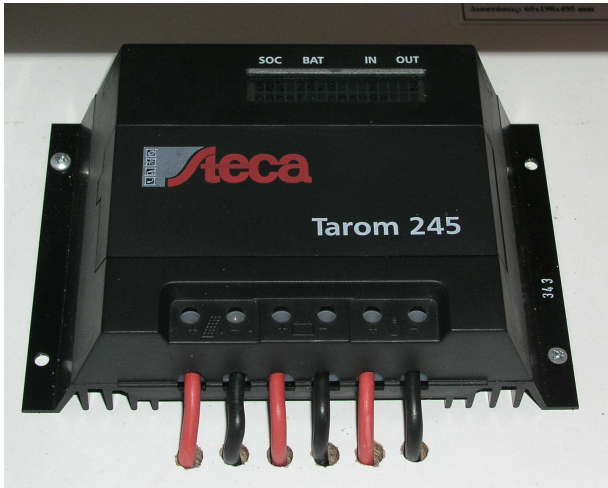
(σχήμα 58) Ελεγκτής ρεύματος Tarom 245 οίκου Steca.
