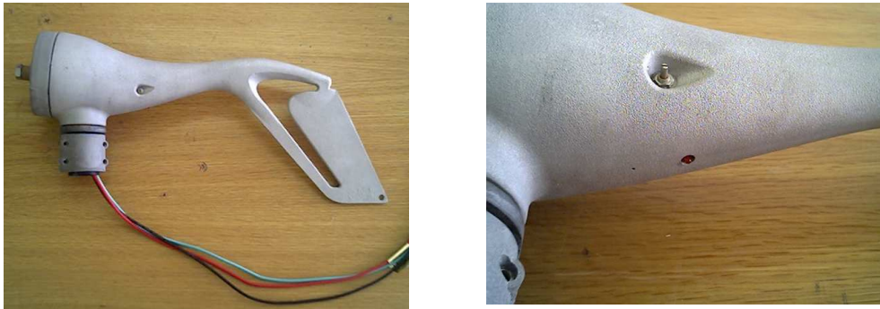
(σχήμα 32) AIR-X Land Το σώμα της Α/Γ (λεπτομέρεια ποτενσιόμετρο και LED).
