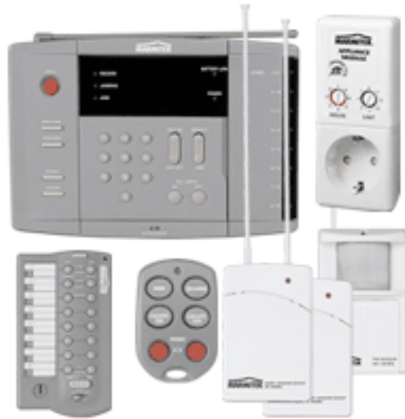
Εικόνα 12 : Κεντρική κονσόλα και περιφερειακές συσκευές στο σύστημα συναγερμού MS 9770
