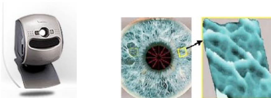
Εικόνα 20 : Συσκευή αναγνώρισης ίριδας της εταιρίας Senex. Αναγνώριση και δομή της ίριδας από την συσκευή.
