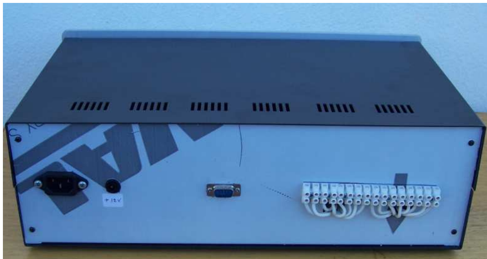
Σχήμα 4.4: Πίσω όψη της συσκευής. Βλέπουμε τις τροφοδοσίες της συσκευής 220V και +12V, την σειριακή θύρα όπου θα γίνετε η επικοινωνία με το κινητό τηλέφωνο, καθώς και τον συνδετήρα όπου θα συνδεθούν πάνω τα φορτία μας.
