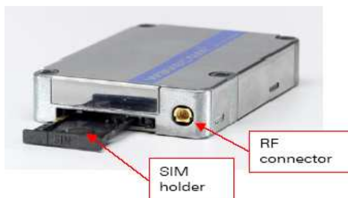
Σχήμα 2.3: Υποδοχή για την κάρτας SIM, και την κεραίας του GSM μόντεμ.
