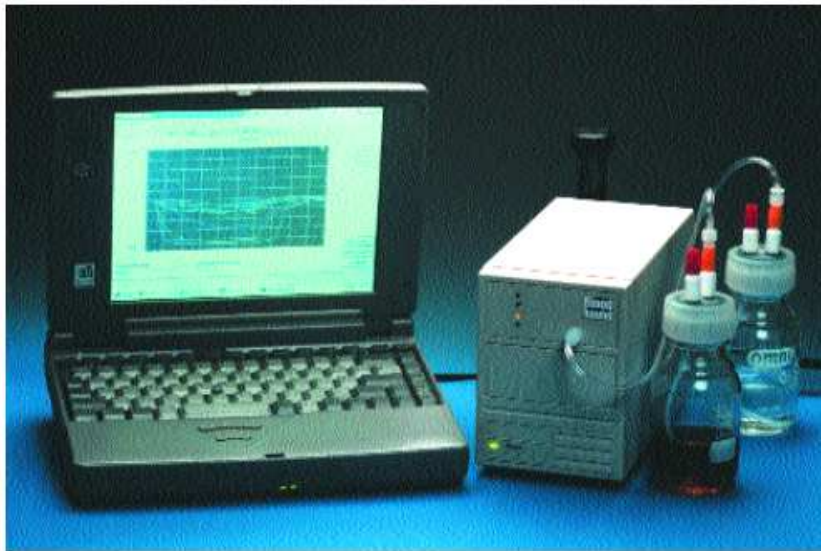
Σχήμα 4.14. Συντονισμένες χρήσεις σειρές συστημάτων του BH 114 λαγωνικού πολλαπλάσιων αισθητήρων αερίου για να μετρήσει και να καταγράψει τα fragrances, τις μυρωδιές, και τα μίγματα πτητικών ουσιών ως ψηφιακά σχέδια.
