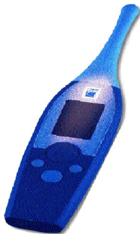
Σχήμα 4.15. Πρωτότυπο της φορητής, με μπαταρίες ηλεκτρονικής μύτης Cyrano, στην οποία οι ατμοί τραβιούνται μέσω του ελέγχου και πέρα από τη σειρά αισθητήρων τα αποτελέσματα επιδεικνύονται σε μια επιτροπή LCD.
