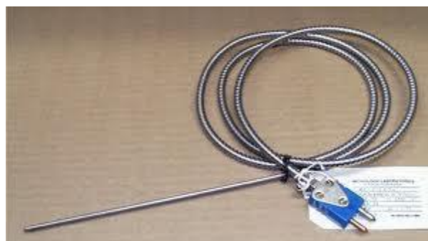
Σχήμα 3.9 :Χαλκός και constantan
