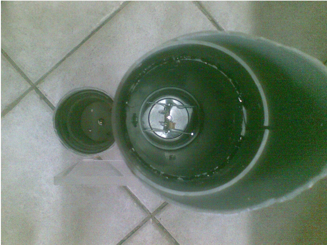
Εικόνα 71: Ευθυγραμμισμένοι πομπός και δέκτης από το εμπρός μέρος Πάνω στην πλάκα αυτή επίσης προσαρμόζονται και οι βάσεις στήριξης της κατασκευής, και μια μικρή βάση για το ηλεκτρολογικό κουτί προδιαγραφών IP56 [15] με αντίστοιχα glands που περικλείει την πλακέτα του Media Converter.
