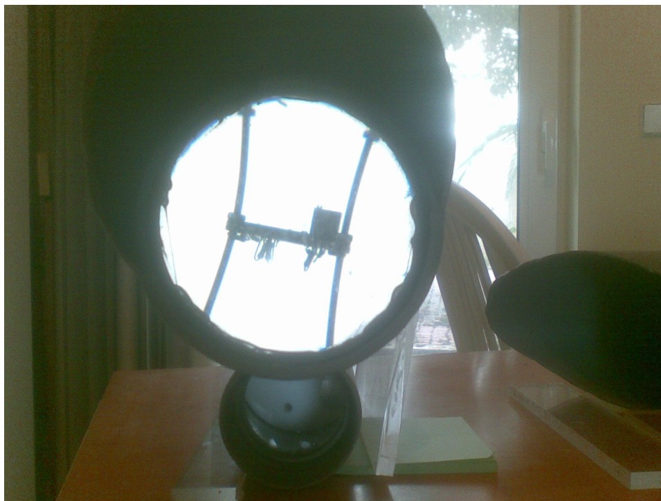
Εικόνα 66: Η πλακέτα του δέκτη ευθυγραμμισμένη μέσα από το φακό μεγέθυνσης μπροστά από το δέκτη
