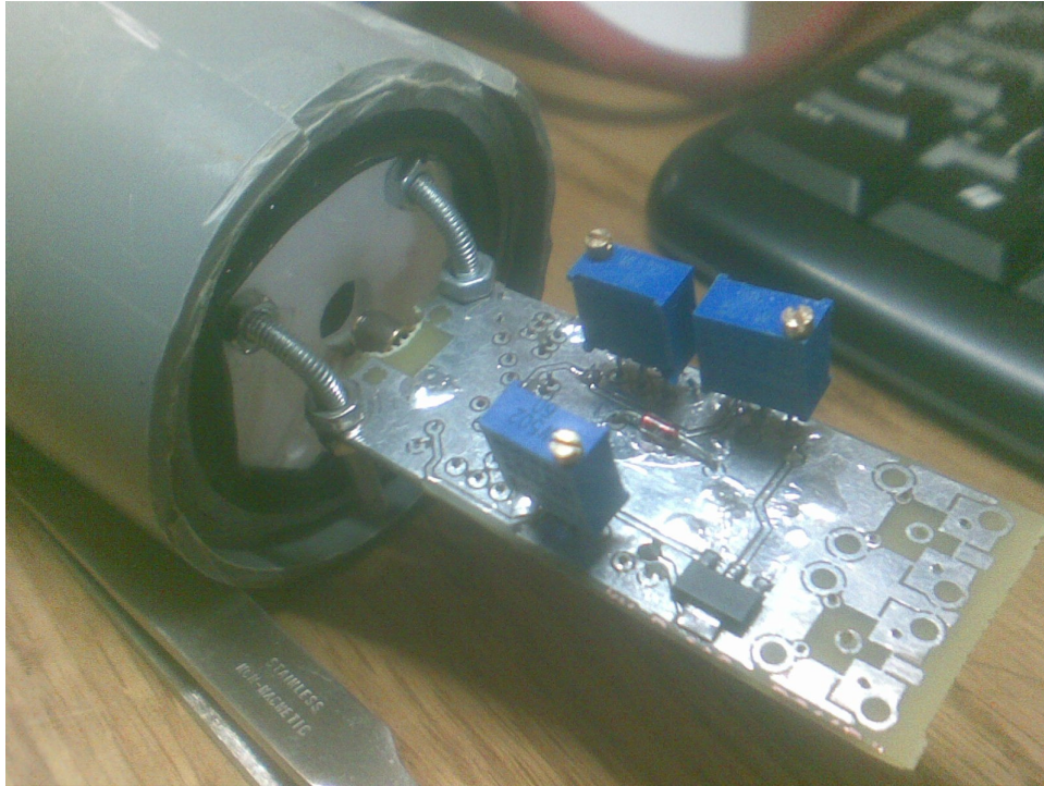
Εικόνα 69: Η πλακέτα του πομπού και η βάση στήριξης με τις ντίζες ευθυγράμμισης πριν κολληθούν οι SMA Connectors
