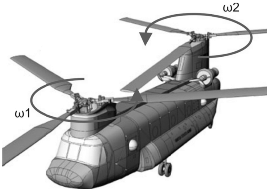
Σχήμα 2.4 : Ομοαξονικό ελικόπτερο (παρουσιάζεται ο τρόπος αλληλεξουδετέρωσης των δύο αντίρροπων δυνάμεων)
