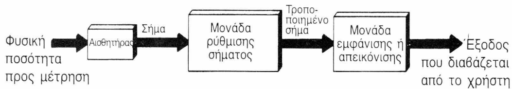
Σχήμα 4: Σχηματική δομή μίας αλυσίδας μετρήσεων
