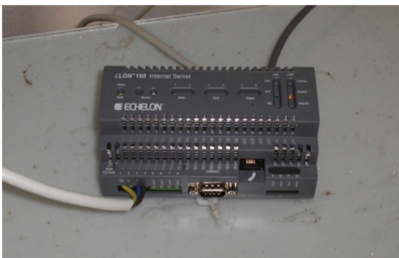
Εικόνα 3.10 Η συσκευή αποθήκευσης δεδομένων iLON100
