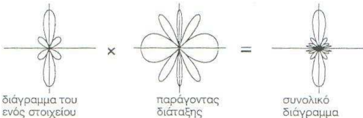
Σχ. 50: Διάγραμμα ακτινοβολίας κεραίας N=8 , d=\lambda/2
