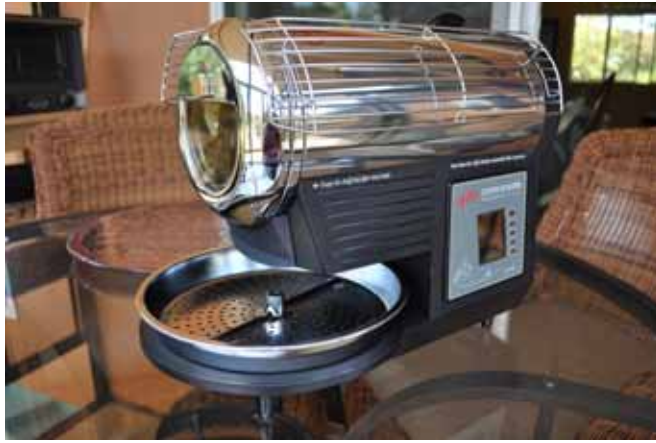
Εικ.4 Περιστρεφόμενο τύμπανο για τη θέρμανση του καφέ.
