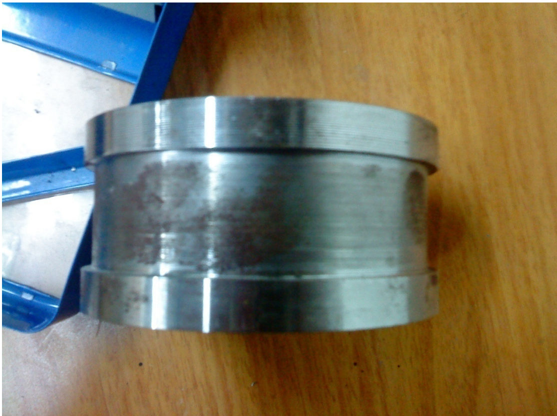
Εικόνα 5-7: Ο μεταλλικό πυρήνας του στάτη μετά την κατεργασία και πριν τον τελευταίο καθαρισμό του
