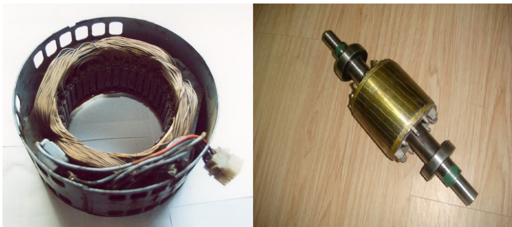
Εικόνα 5-1: Στάτης και ρότορας από κινητήρα πλυντηρίου
