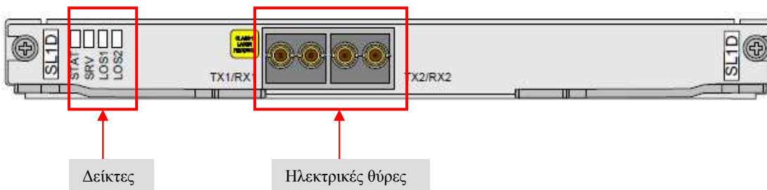
Εικόνα 102 . Πρόσοψη του SL1D(με ηλεκτρικές θύρες).
