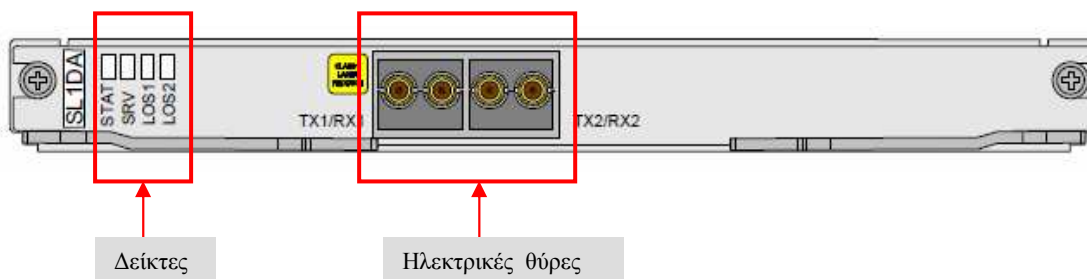
Εικόνα 103. Πρόσοψη του SL1DA(με ηλεκτρικές θύρες).
