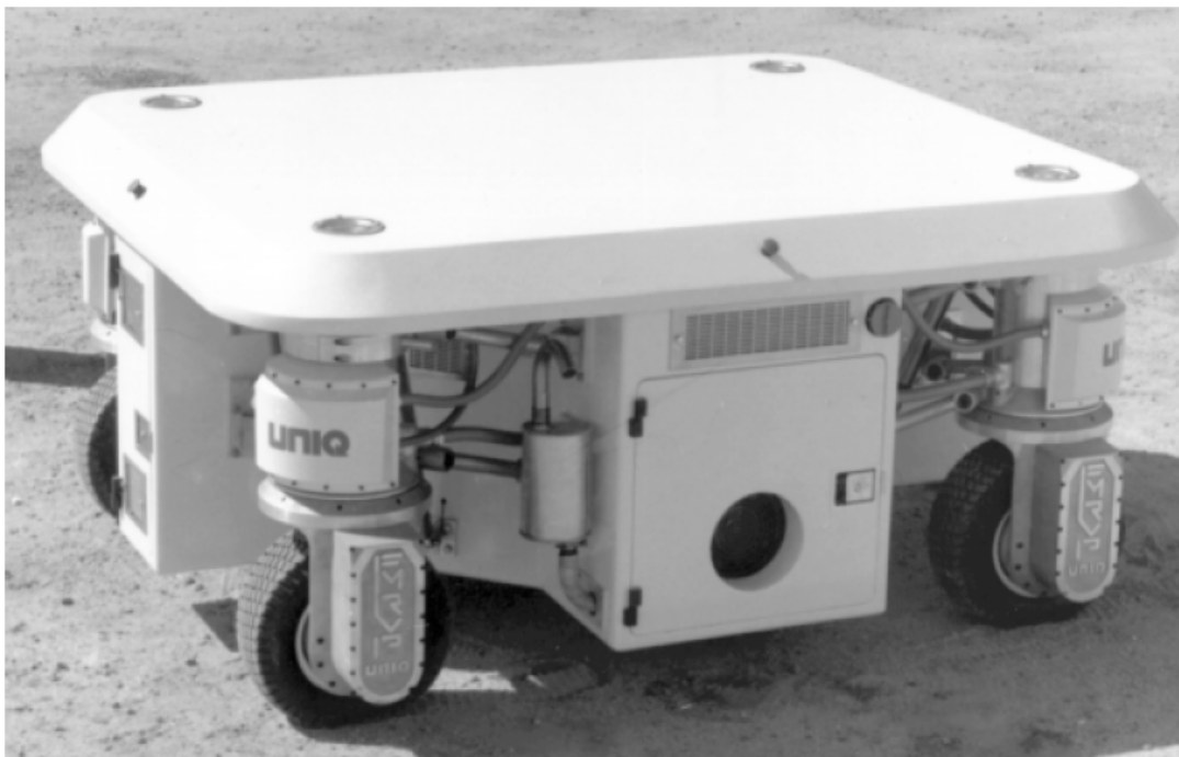
Εικόνα 4.11 Πλατφόρμα 8 επιπέδων ελευθερίας με 4 τροχούς που καθοδηγείται και κατευθύνεται μεμονωμένα. Σχεδιάστηκε και κατασκευάστηκε από την Unique Mobility, Inc [J.Borenstein, H. R. Everett and L. Feng, 1996].
