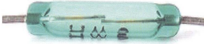
Εικόνα 2.4 Τυπικό δείγμα μαγνητικού διακόπτη με γλωσσίδια [Καλοβρέκτης Κωνσταντίνος, Κατέβας Νικόλαος, 2013]
