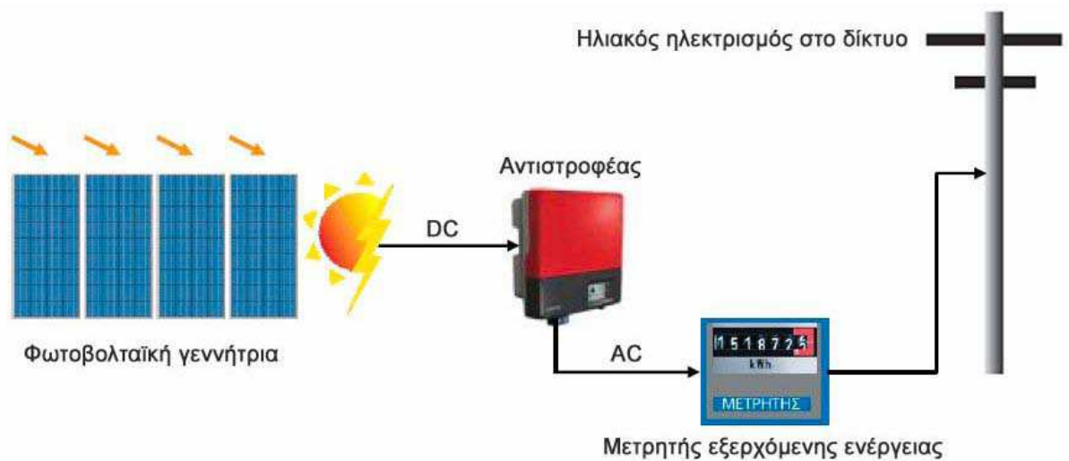
Εικόνα 23: Διασυνδεδεμένο σύστημα με το δίκτυο
