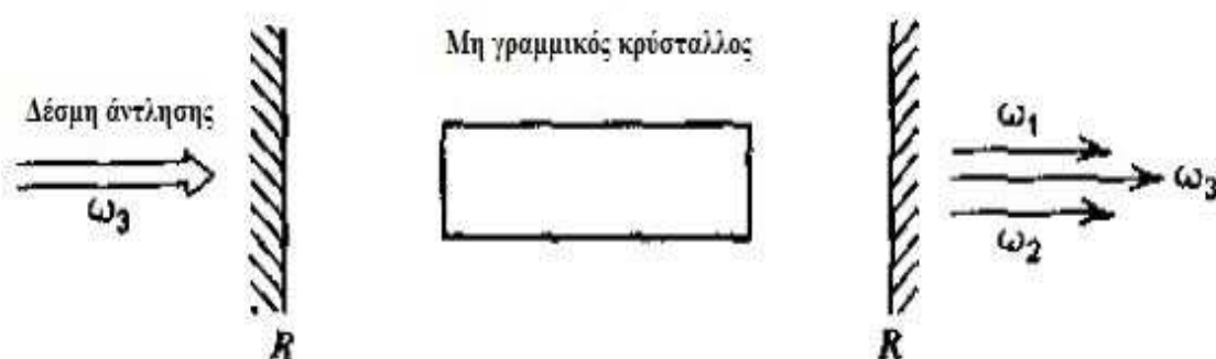
Σχ. 9.1 Σχηματικό διάγραμμα ενός παραμετρικού ταλαντωτή
