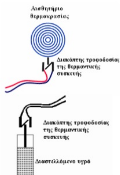
Εσωτερική δομή των αισθητηρίων θερμοκρασίας του μηχανικού θερμοστατη
