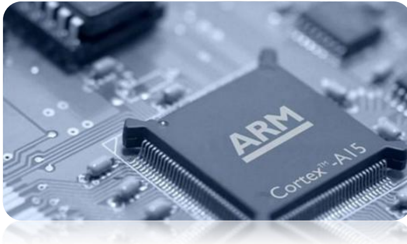
Εικόνα 4.1: Ο επεξεργαστής Cortex-A15 της ARM [31]
