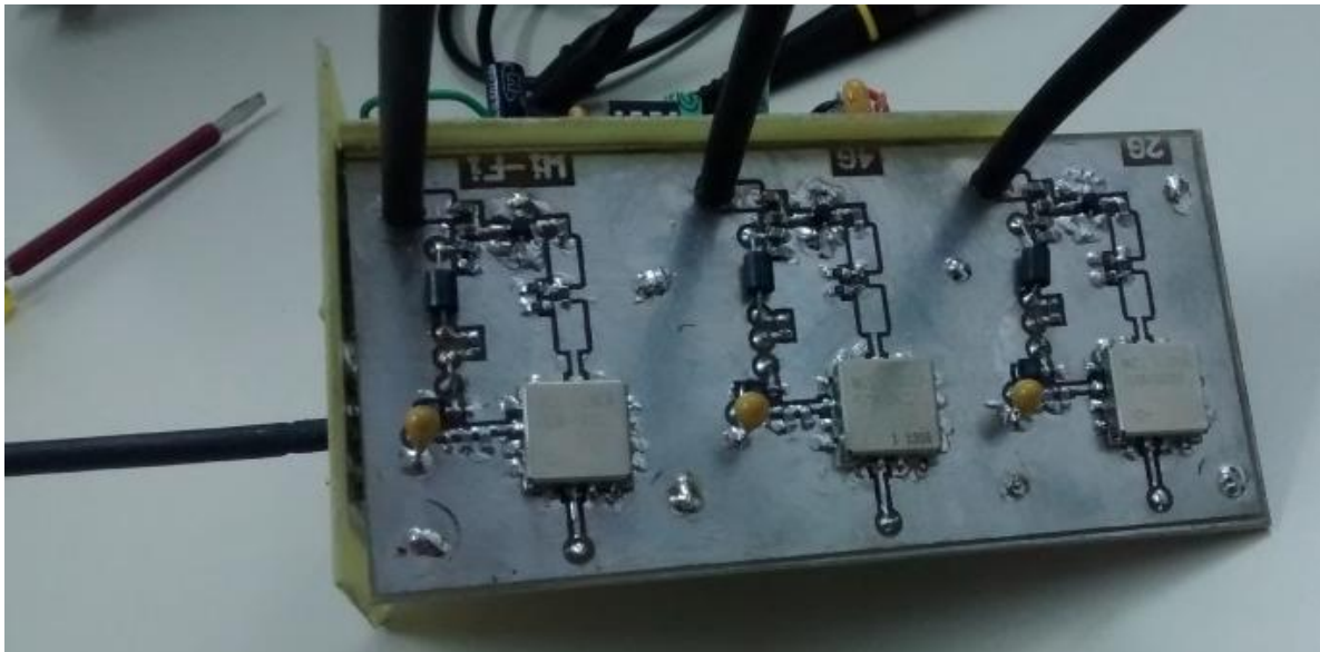
Εικόνα 3.5: Κύκλωμα Τριών Ταλαντωτών
