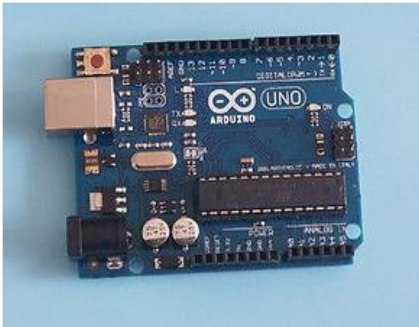
Σχήμα 2.21 : Αναπτυξιακή πλακέτα Arduino Uno
