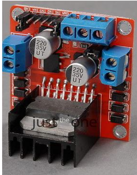
Σχήμα 2.12 : Ηλεκτρονικό κύκλωμα επιλογής φοράς κίνησης στους κινητήρες
