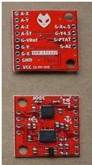
Σχήμα 2.11 : Αναλογικά Αισθητήρια (Επιταχυνσιόμετρο ,Γυροσκόπιο)
