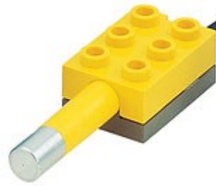
9-Volt Αισθητήρας θερμοκρασίας. Ευαισθησία: -20 έως +50 βαθμούς Κελσίου
