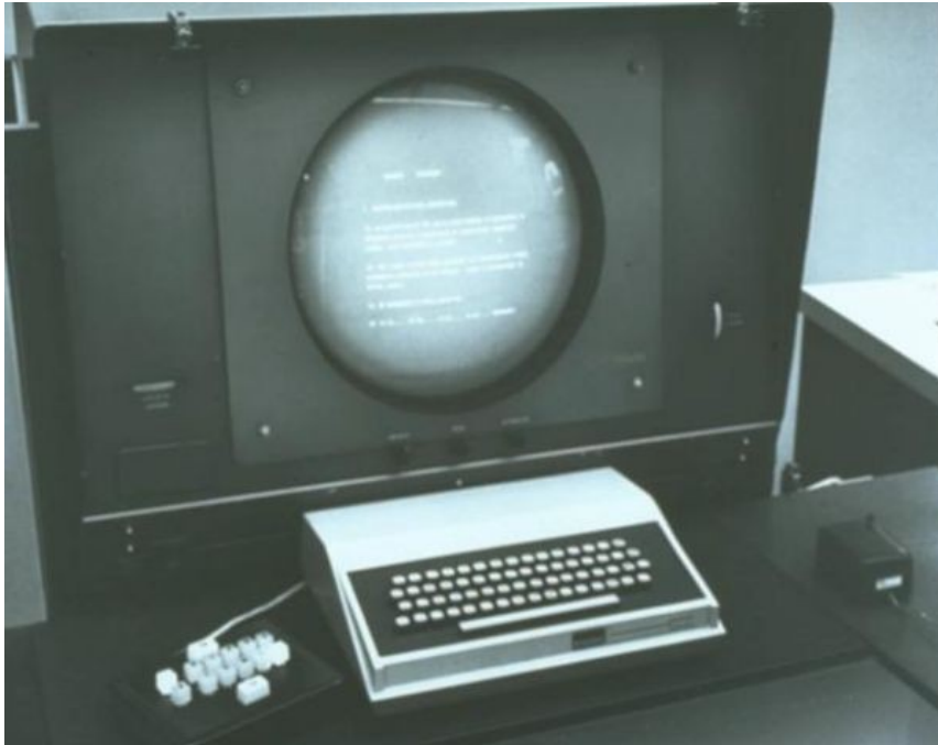
Το NLS με την οθόνη, το πληκτρολόγιο, τα επιπλέον πλήκτρα του και το ποντίκι.
