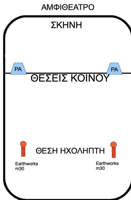
Εικόνα 20: Θέση earthworks m30 στη θέση κοινού-ηχολήπτη
