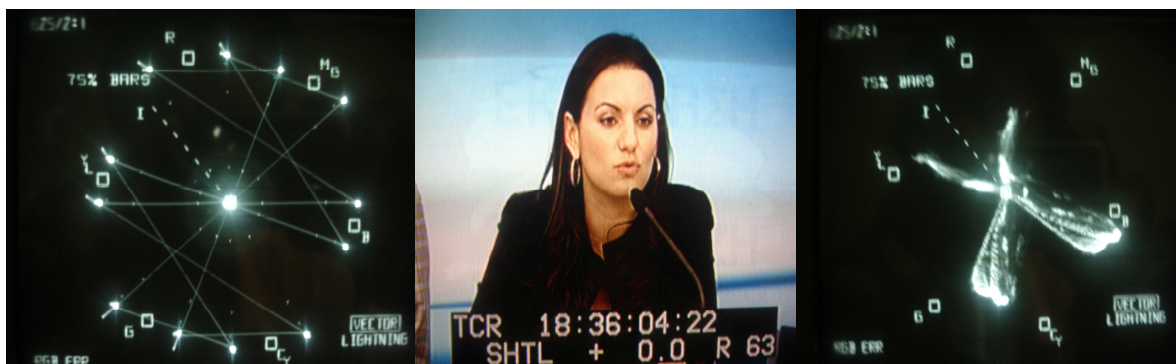
Σχήμα 5.1.2 Η φάση των χρωματοδιαφορών είναι διαφορετική και συνεπώς και η εικόνα δεν θα αποδίδεται σωστά ως προς τα χρώματα.
