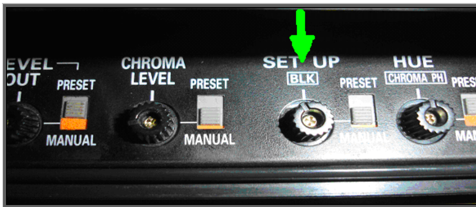
Σχήμα 5.2.1 Η διάταξη του TBC με το ποτενσιόμετρο ελέγχου των μαύρων.
