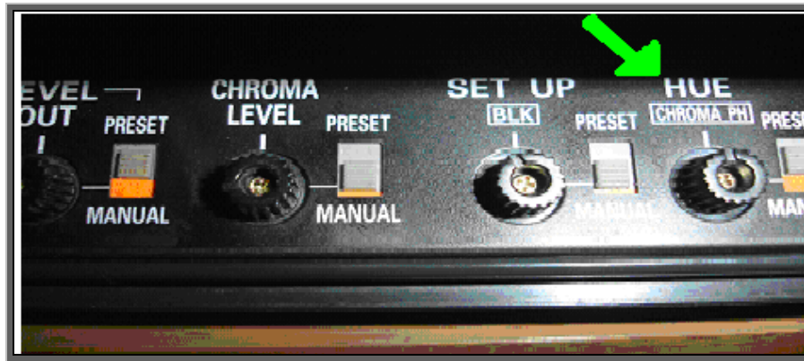
Σχήμα 5.1.1 Η διάταξη του TBC με το ποτενσιόμετρο ελέγχου του HUE CHROMA PH.
