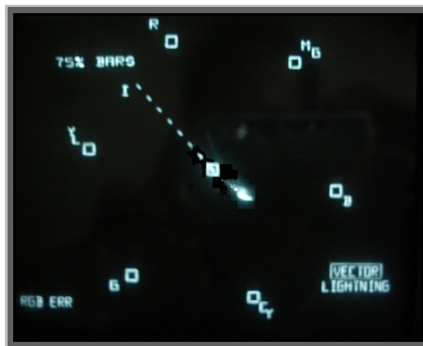
Σχήμα 5.3.16 Η εικόνα με το λάθος balance όπως φαίνεται στον διανυσματογράφο.
