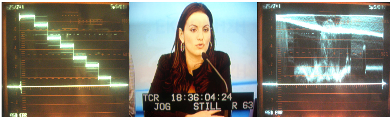
Σχήμα 5.2.5 Η στάθμη φωτεινότητας της άσπρης μπάρας είναι λίγο πιο πάνω από τα 0,7 Volt και συνεπώς τα άσπρα της εικόνας μας θα κλιπάρουν.
