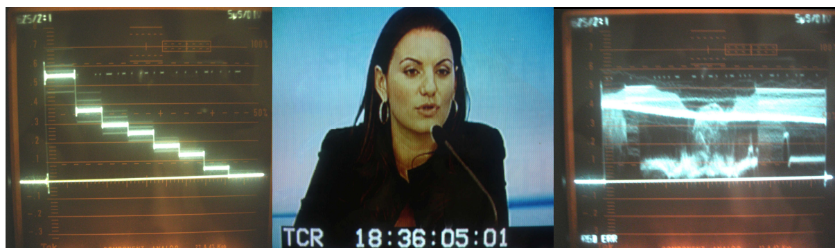
Σχήμα 5.2.6 Η στάθμη φωτεινότητας της άσπρης μπάρας πέφτει πιο κάτω από τα 0,7 Volt και συνεπώς η εικόνα μας θα σκοτεινιάσει.
