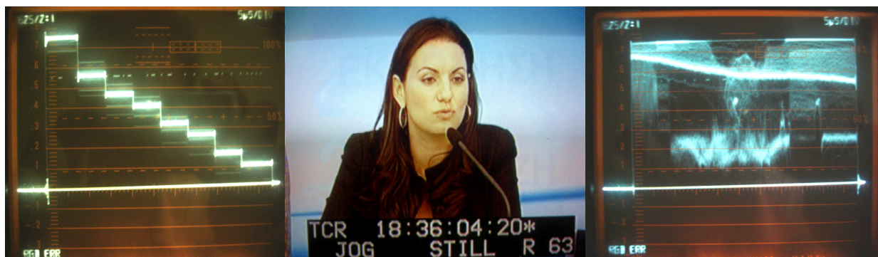
Σχήμα 5.2.2 Η στάθμη της φωτεινότητας της μαύρης μπάρας είναι υψηλή και συνεπώς η εικόνα μας θα έχει τα μαύρα σηκωμένα κοντά στο 0,1 Volt.
