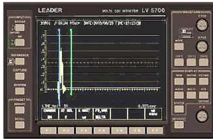
Σχήμα 5.8.4 Ο παλμός SAV τοποθετείται κάτω από την μπλέ γραμμή.
