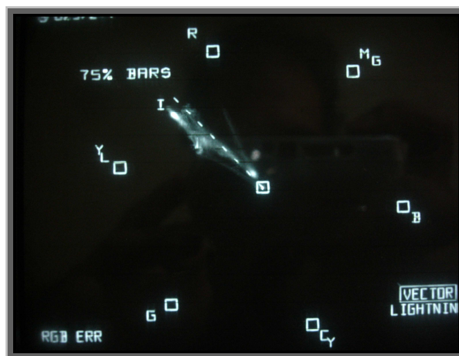
Σχήμα 5.3.19 Η εικόνα με το λάθος balance όπως φαίνεται στον διανυσματογράφο.
