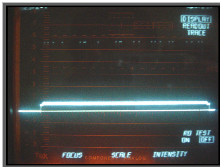
Σχήμα 5.3.3 Η στάθμη φωτεινότητας για το μαύρο πρέπει να πέφτει πάνω στο 0 και όχι πάνω από αυτό όπως παρουσιάζεται στην εικόνα.
