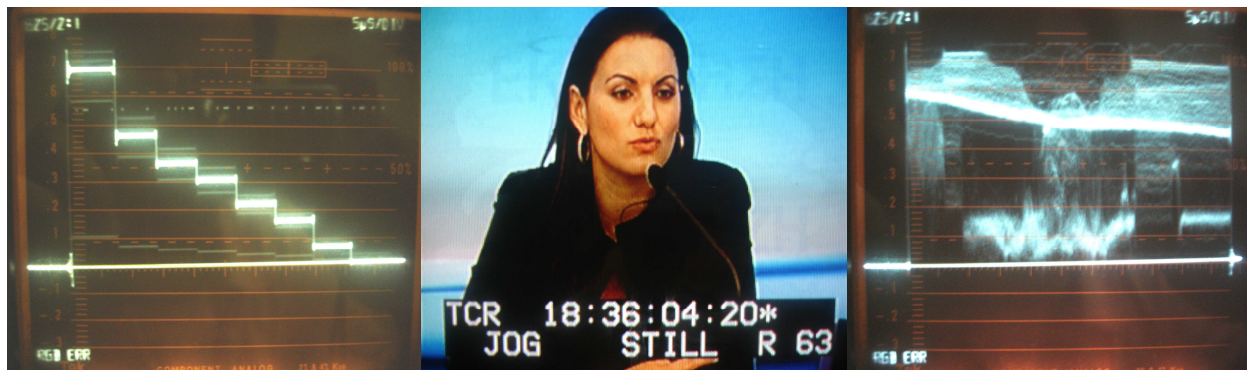
Σχήμα 5.2.3 Η στάθμη της φωτεινότητας της μαύρης μπάρας είναι στο σημείο 0 και συνεπώς τα μαύρα της εικόνας μας θα πέφτουν πάνω στο σημείο 0.
