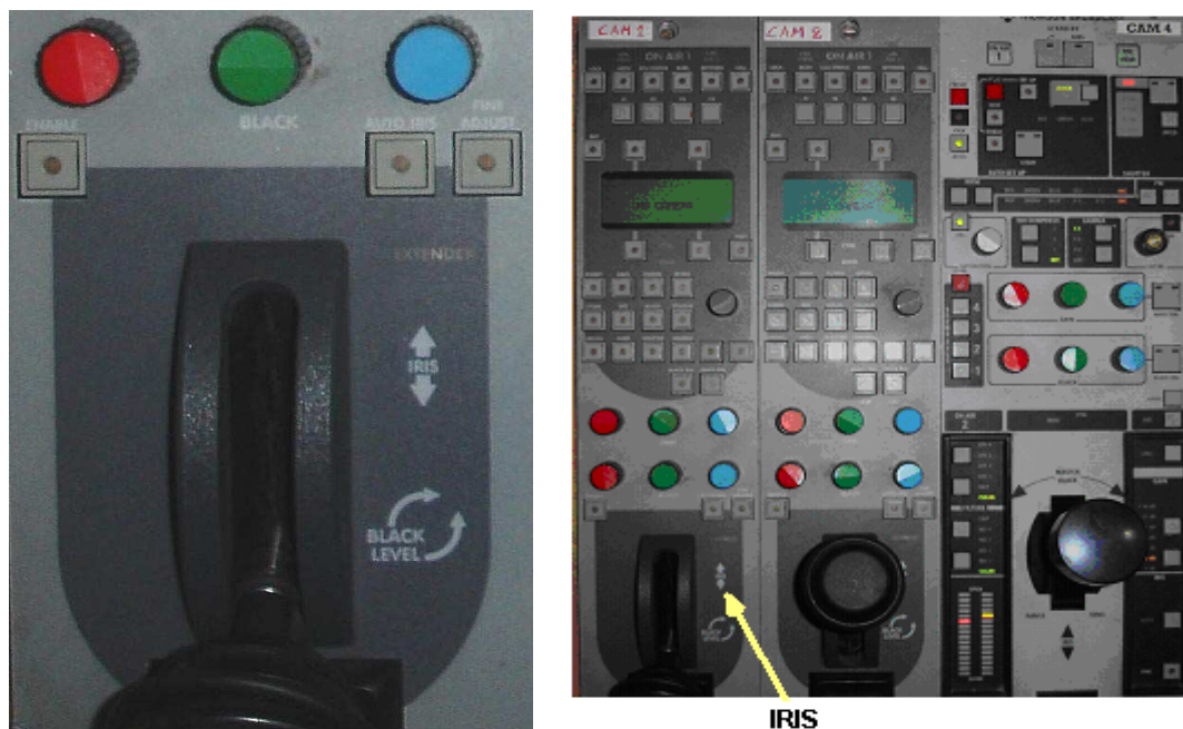
Σχήμα 5.3.9 Ο μοχλός ελέγχου IRIS που υπάρχει σε κάθε μονάδα CCU.
