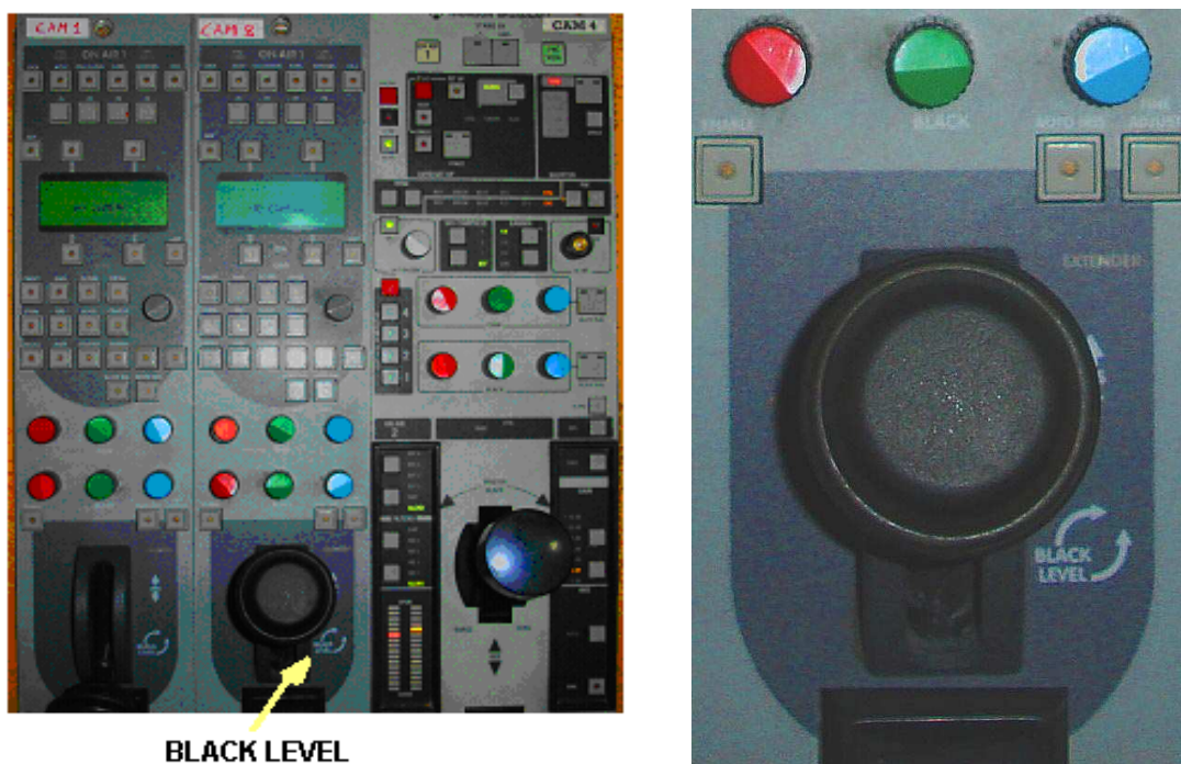
Σχήμα 5.3.4 Οι τρεις μονάδες CCU με τους μοχλούς ελέγχου του black level σε κάθε μονάδα.
