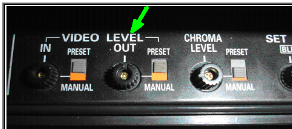
Σχήμα 5.2.4 Η διάταξη του TBC με το ποτενσιόμετρο του VIDEO LEVEL.
