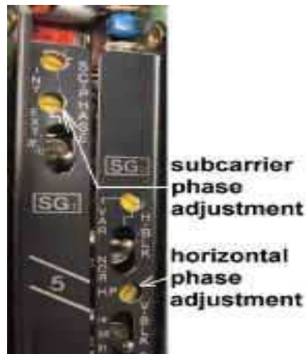
Σχήμα 5.5.2 Τα ποτενσιόμετρα συγχρονισμού της κάμερας.
