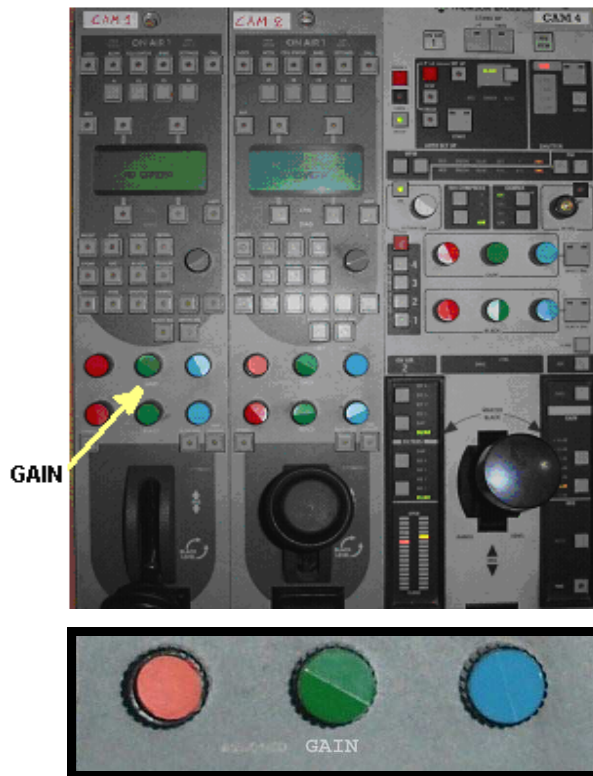
Σχήμα 5.3.11 Οι μονάδες CCU με τα ποτενσιόμετρα ελέγχου του άσπρου.
