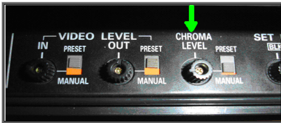
Σχήμα 5.2.7 Η διάταξη του TBC με το ποτενσιόμετρο του CHROMA LEVEL.
