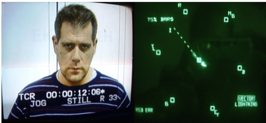
Σχήμα 3.6.2 Η απεικόνιση της χροιάς και του κορεσμού της εικόνας στον διανυσματογράφο.
