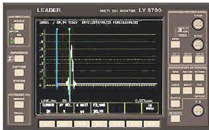
Σχήμα 5.8.3 Ο κέρσορας (πράσινη γραμμή) τοποθετείται πάνω στον παλμό SAV του συγκεκριμένου καναλιού.
