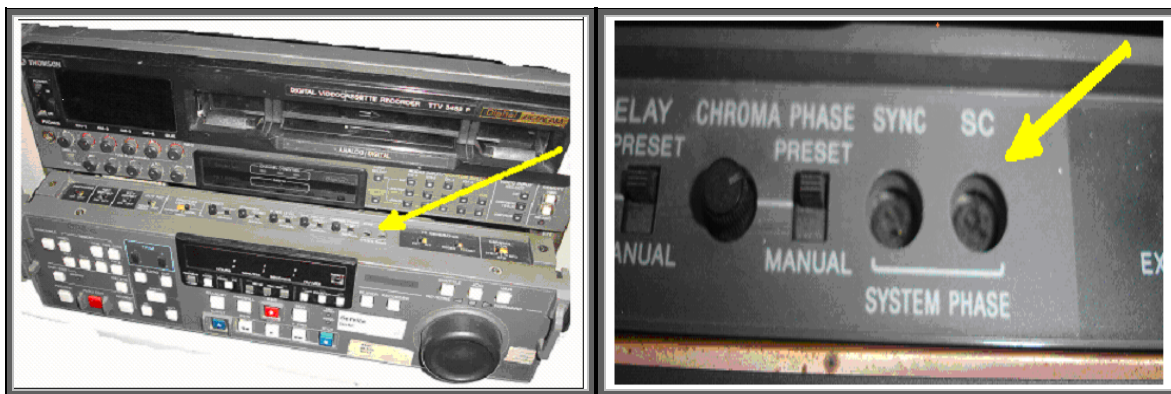
Σχήμα 5.5.1 Τα δύο ποτενσιόμετρα τα οποία παρουσιάζονται και σε μεγέθυνση είναι τοποθετημένα πάνω στην διάταξη του TBC του VCR.
