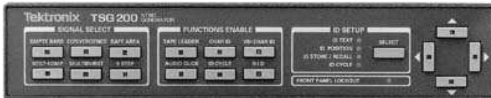
Σχήμα 5.4.2 Η γεννήτρια η οποία παρέχει το σήμα συγχρονισμού.
