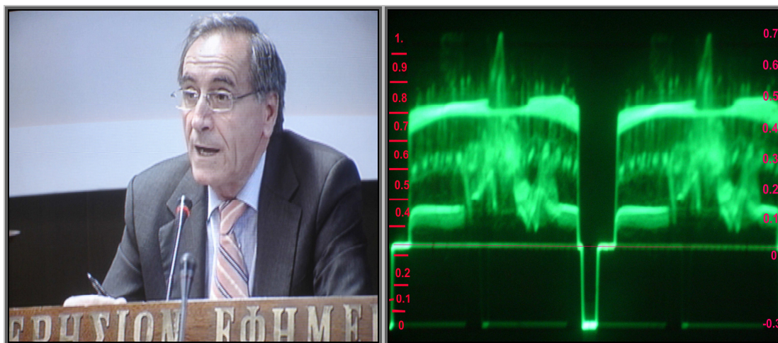
Σχήμα 3.4.3 Η απεικόνιση της εικόνας δεξιά, όπως φαίνεται στον παλμογράφο αριστερά, ο οποίος δουλεύει στην κλίμακα των Volt.
