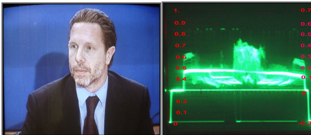
Σχήμα 3.4.4 Η απεικόνιση της εικόνας αριστερά, όπως φαίνεται στον παλμογράφο δεξιά,, ο οποίος δουλεύει στην κλίμακα των Volt.
