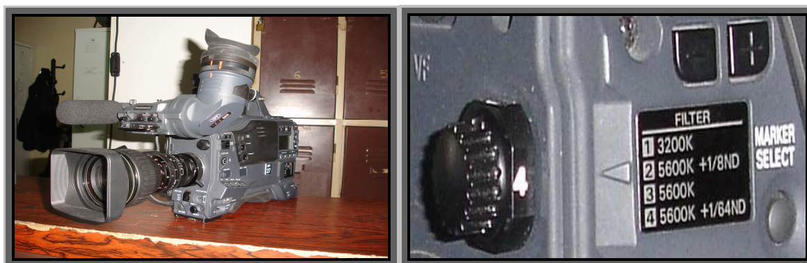
Σχήμα 3.7.3 Μια επαγγελματική κάμερα και οι θέσεις των φίλτρων αριστερά.
