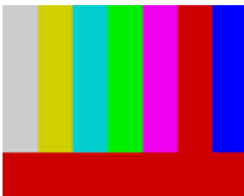
Σχήμα 3.2.1 Το σήμα δοκιμής είναι οι γνωστές μπάρες.
