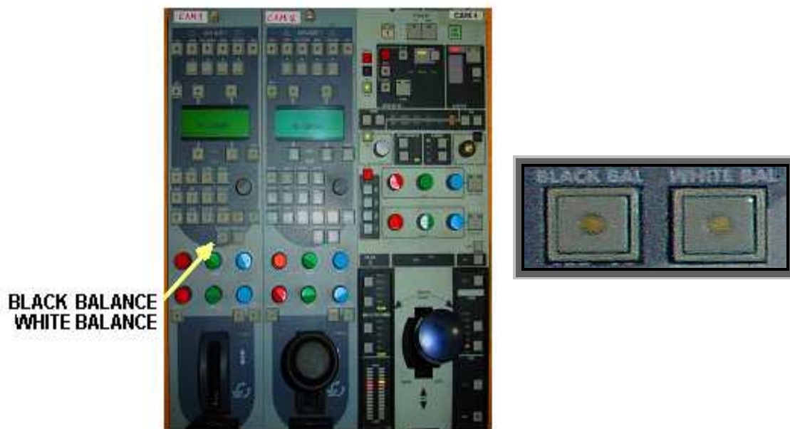
Σχήμα 5.3.2 Οι τρεις μονάδες των CCU και οι διακόπτες για το BLACK και WHITE BALANCE.
