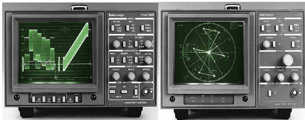
Σχήμα 3.1.1 Το όργανο μέτρησης της στάθμης του σήματος είναι ο παλμογράφος (αριστερά) και το όργανο μέτρησης του πλάτους της χρωμικότητας και της φάσης των χρωματοδιαφορών είναι ο διανυσματογράφος (δεξιά).
