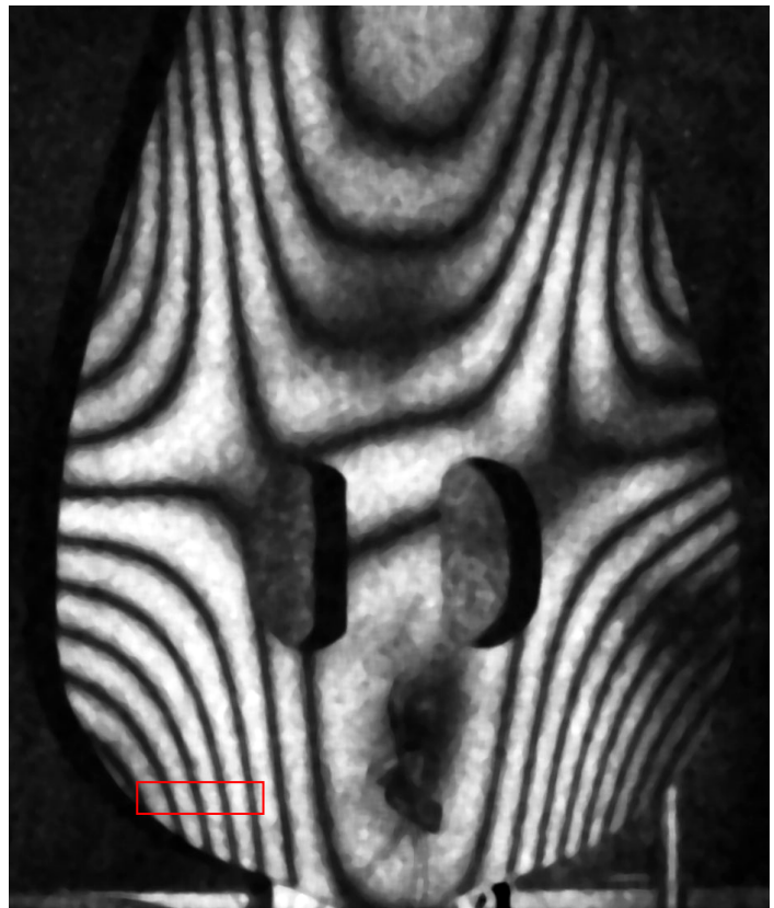
Σχήμα 8: Συμβολόγραμμα του κανονικού τρόπου ταλάντωσης σε συχνότητα 1106Hz για την λύρα τύπου Σταγάκη (α) πριν, και (β) μετά την εφαρμογή της στροβοσκοπίας. Με κόκκινο πλαίσιο οι περιοχές του συμβολογράμματος που αναλύθηκαν με ειδικό λογισμικό.
