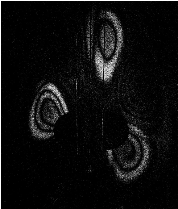
Σχήμα 13: (α) Συμβολόγραμμα του κανονικού τρόπου ταλάντωσης σε συχνότητα 1663Hz για τη λύρα τύπου Σταγάκη πριν την εφαρμογή διαμόρφωσης φάσης. (β) και (γ) μετά την εφαρμογή διαμόρφωσης φάσης, αλλάζοντας το πλάτος δόνησης του πιεζοηλεκτρικού στοιχείου κατά \sim 0,15\mu\text{m} και \sim 0,30\mu\text{m} αντίστοιχα.
