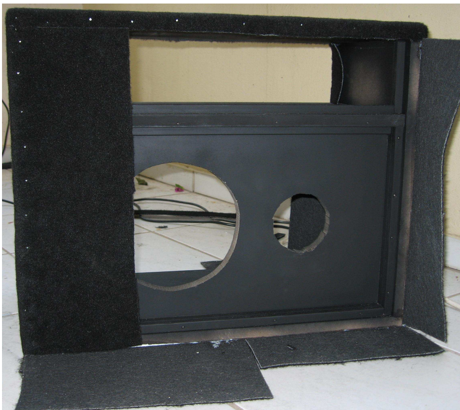
Σχήμα 42. Τοποθέτηση του ξύλου που θα δεχθεί τα μεγάφωνα καθώς και της μοκέτας.
