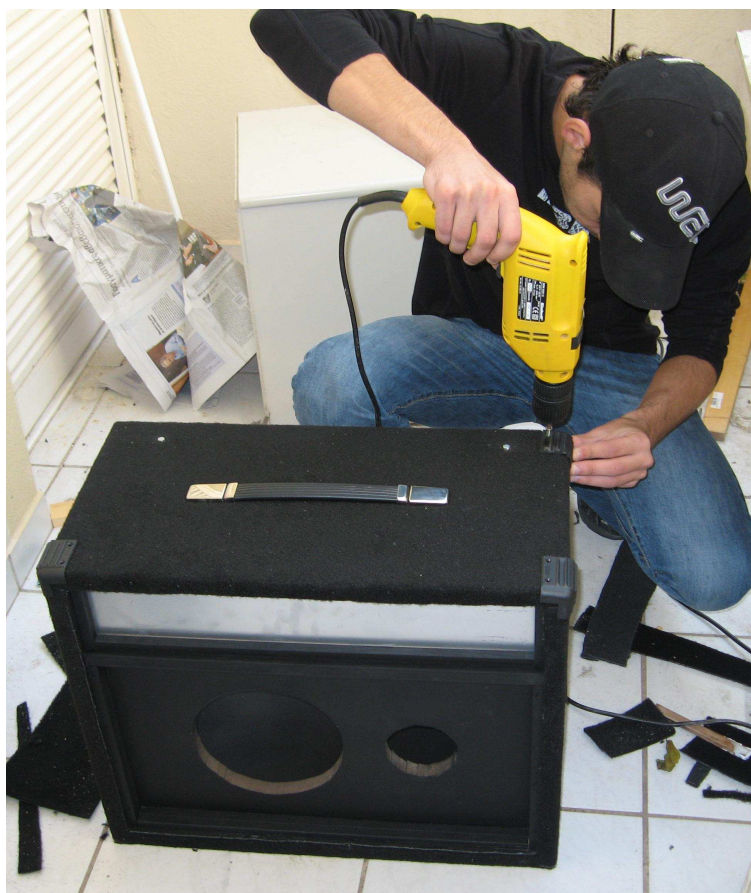
Σχήμα 43. Τοποθετήθηκαν χερούλια και γωνίες.
