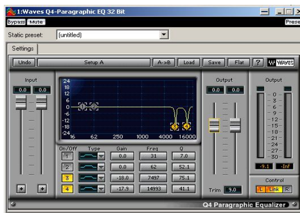
Εικόνα 2.5.4: Φασματογράφημα για εντοπισμό των ενοχλητικών συχνοτήτων και αφαίρεση με equalizer.
