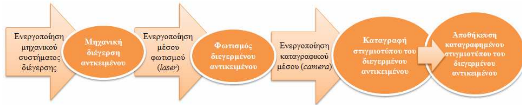
Σχήμα 3.2: Διαδικασία πειραματικών ενεργειών για την καταγραφή του φαινομένου της κίνησης σε ελεγχόμενα διεγερμένο αντικείμενο
