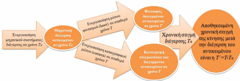
Σχήμα 3.3: Καταγραφή συγκεκριμένης χρονικής στιγμής ( T'=T-T_a ) της εξέλιξης της κίνησης σε μηχανικά διεγερμένο αντικείμενο
