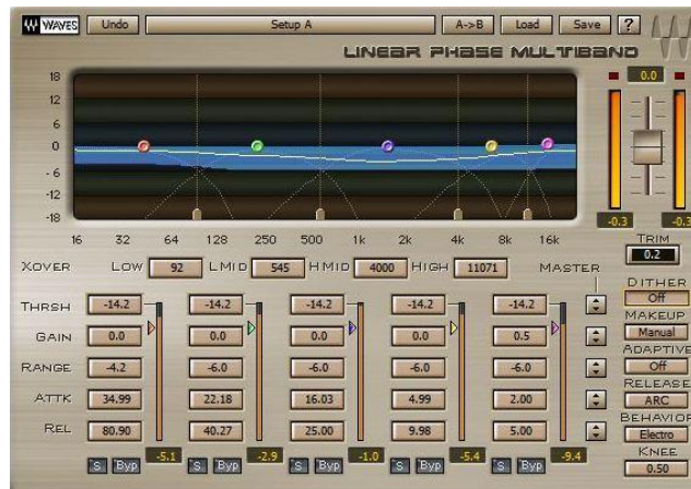
Εικόνα 53: Multiband Compressor με πέντε διαφορετικές συχνотικές περιοχές
