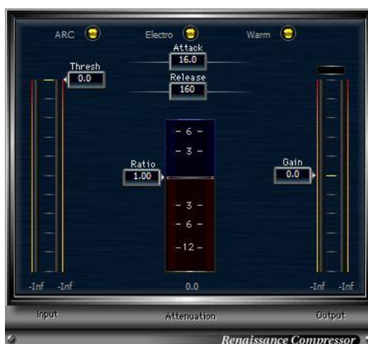
Εικόνα 48: Τυπικός δυναμικός επεξεργαστής τύπου compressor
