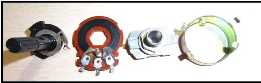
Εικόνα 6: Αποτελούμενα μέρη ενός ποτενσιόμετρου.
