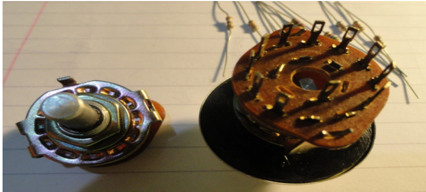
Εικόνα 40: Πάνω και κάτω όψη του κυκλικού διακόπτη 12 θέσεων.
