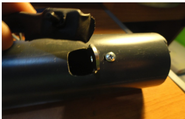
Εικόνα 39: Λαμάκι γωνιά - Στήριξη του αισθητήρα αέρα.
