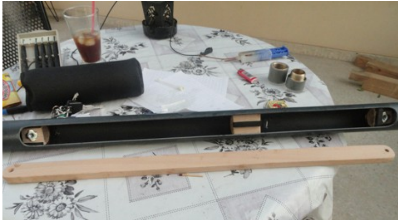
Εικόνα 24: Το κυρίως σώμα με την οπή για το ξύλο του αισθητήρα κίνησης, και τα ξύλα στήριξης του.
