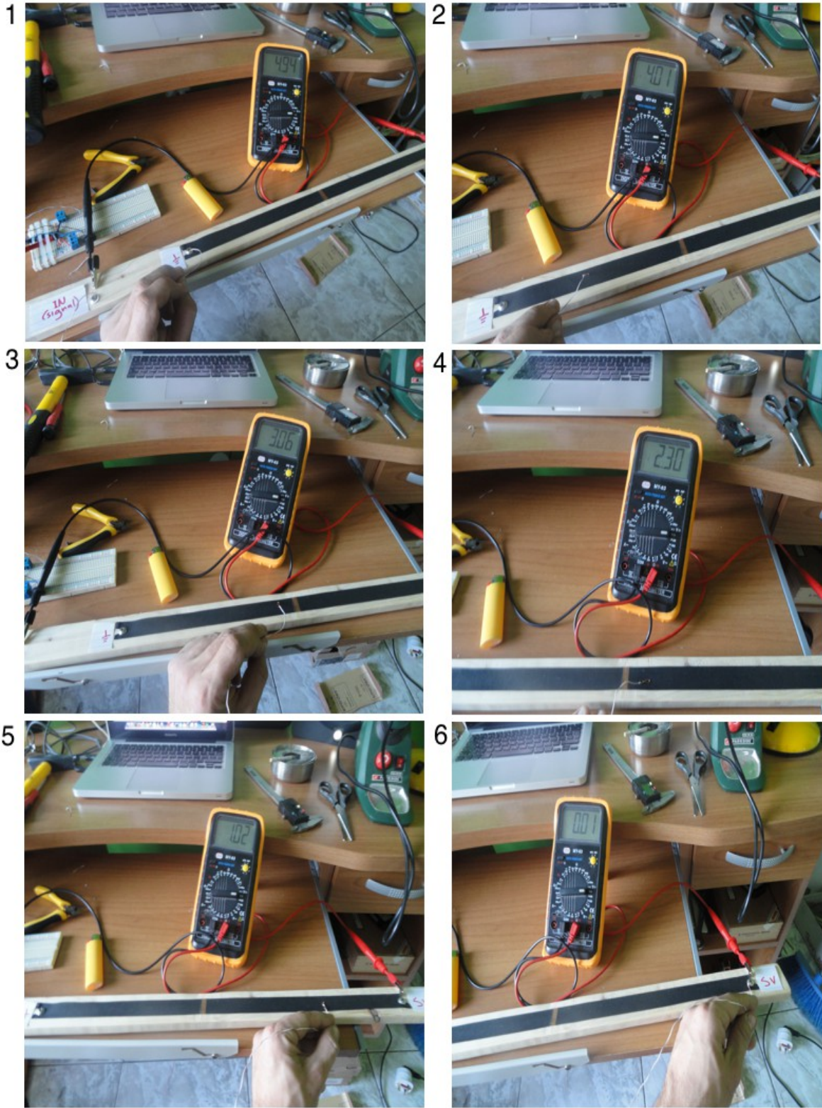
Εικόνα 21: Διαίρεση τάσης του αγώγιμου χαρτιού E.
