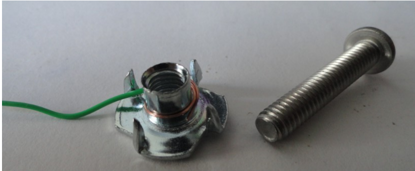
Εικόνα 31: Τύλιγμα καλωδίου γύρω από τον άξονα του καρφωτικού πάσου.
