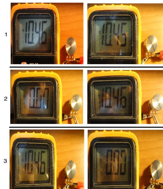
Εικόνα 5: Τρεις περιπτώσεις σύνδεσης ωμόμετρο με ποτενσιόμετρο.
