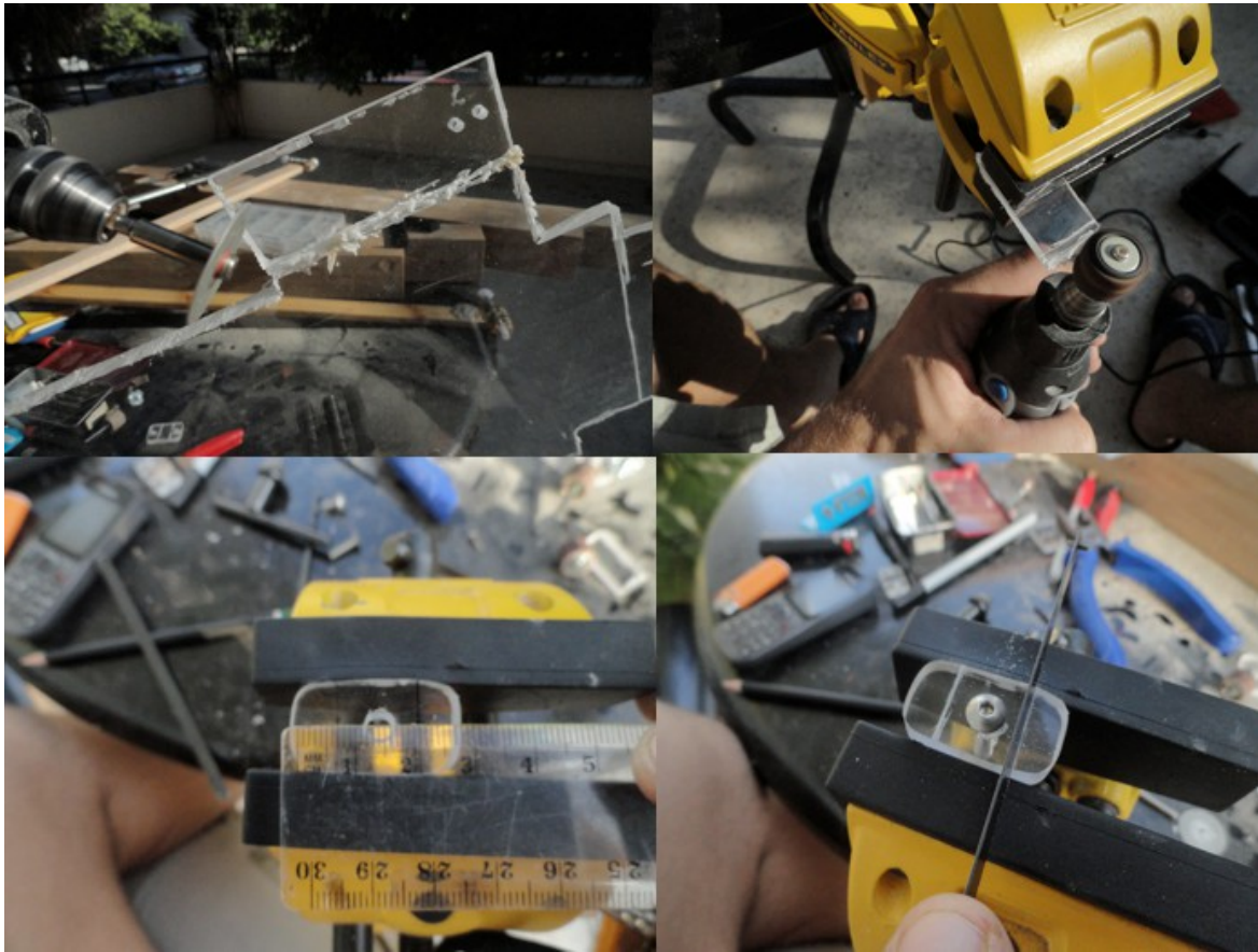
Εικόνα 27: Διαδικασία κατασκευής του καβαλάρη
