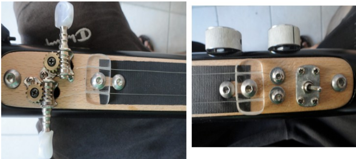
Εικόνα 35: Άνω και κάτω άκρο του αισθητήρα κίνησης με σταθεροποιημένο πάνω το αγώγιμο χαρτί Ε.
