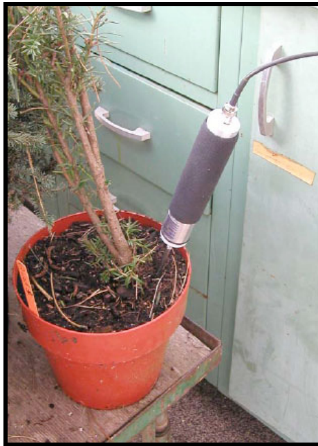
Εικ. 4.8 Ο ειδικός αισθητήρας εισάγεται στο χώμα για την ανίχνευση παρασίτων
