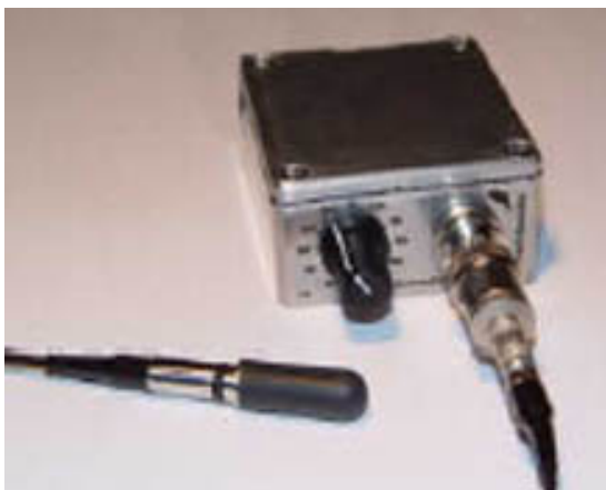
Εικ. 4.25 Υδρόφωνο της Avisoft με μετατροπέα από BNC σε 5 pin XLR ρυθμιζόμενο φίλτρο διέλευσης υψηλών και προενισχυτή
