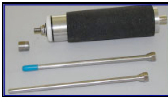
Εικ. 4.12 Ακροσωλήνια επαφής για ανίχνευση διαρροής και για παρακολούθηση λειτουργίας μηχανημάτων
