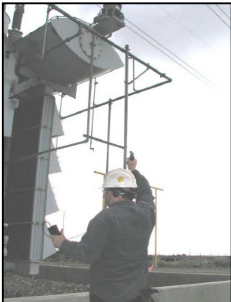
Εικ. 4.17 Ο ABP – 1 Airborne Probe στον έλεγχο εκφόρτισης κορόνας
