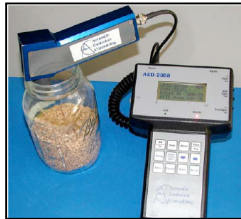
Εικ. 4.16 Ο ABP – 1 Airborne Probe στην ανίχνευση εντόμων μέσα σε κόκκους σταριού
