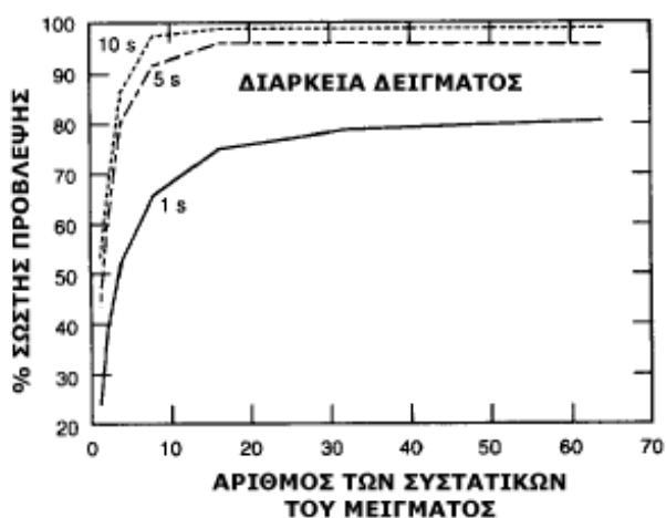
Σχ. 7.15 Απόδοση του συστήματος αναγνώρισης ομιλητή σε συνάρτηση με τον αριθμό των πυκνοτήτων των συστατικών για κάθε μοντέλο ομιλητή, για διάρκειες δείγματος 1, 5 και 10 δευτερόλεπτα.
