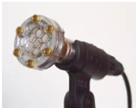
Εικ. 4.26 Μικρόφωνο της Avisoft με επίπεδη απόκριση συχνότητας από 15kHz ως 180kHz
