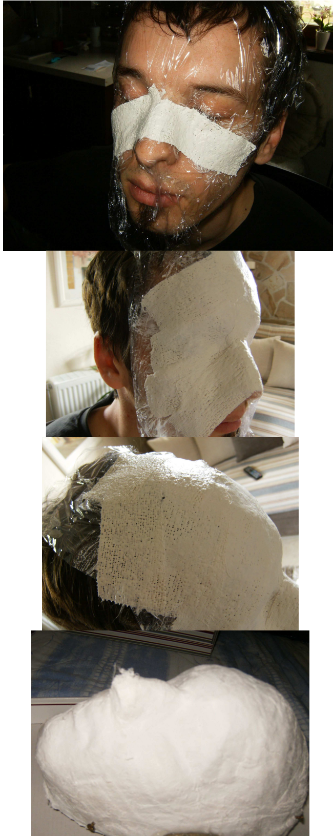
Εικ.5.3. Σταδιακή δημιουργία της dummy head
