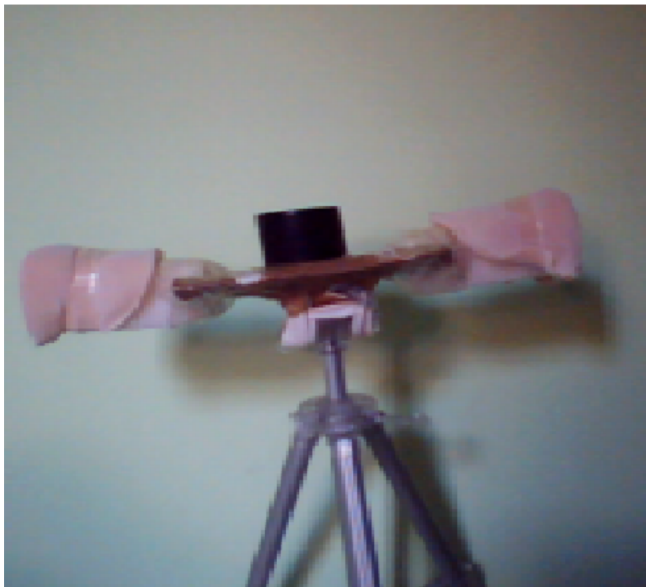
Εικ.5.9. Βάση της dummy head στην οποία φαίνεται το στήριγμα για το λαιμό και ενίσχυση στους ώμους
