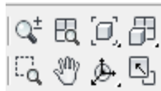
Εικόνα 3.14 Τα viewport controls βοηθούν στον χειρισμό των παραθύρων προβολής (viewports) καθώς και στην κίνηση (animation)
