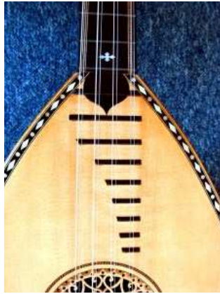
Σχήμα 2.5.4.2 Η κατάληξη της ταστιέρας και τα καλαμάκια (εδώ, από έβενο).
