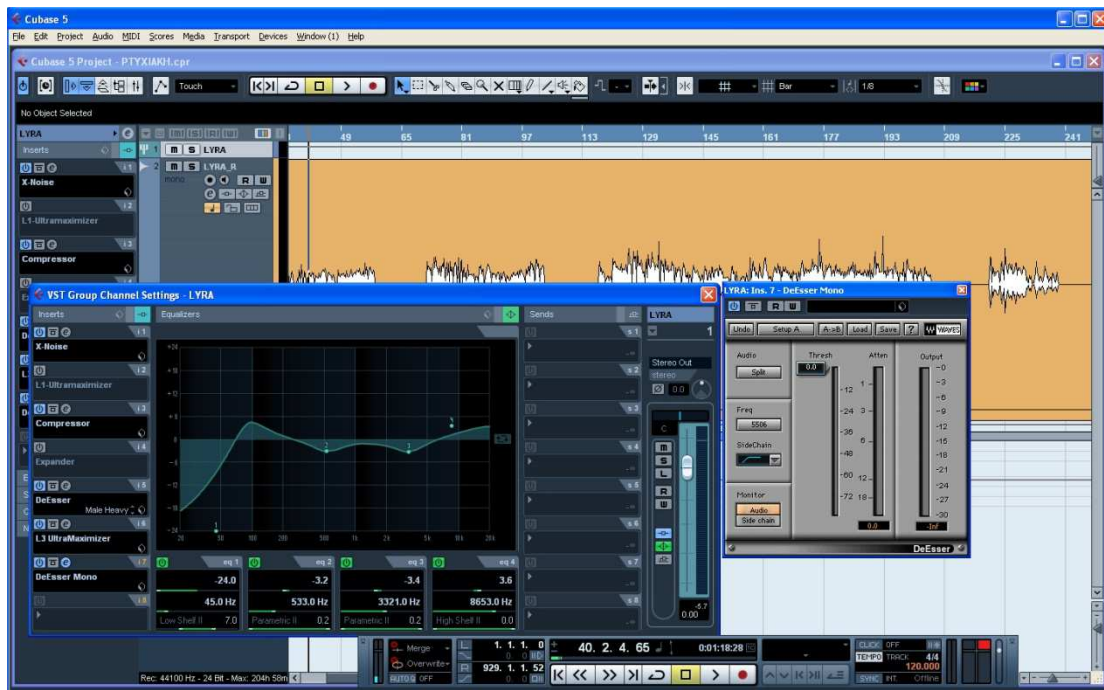
Σχήμα 5.2.2.1 Δραστική επέμβαση στο συχνικό περιεχόμενο του υλικού με την χρήση EQ και DeEsser, με σκοπό την ποιτική καλύτευση.
