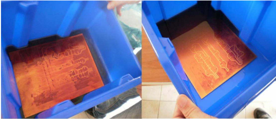
Εικόνα 14: Διακρίνεται η επίδραση του διαλύματος στη φωτισμένη πλακέτα. Αριστερά διακρίνεται η επίδραση στα πρώτα δευτερόλεπτα ενώ δεξιά με το πέρας ενός χρονικού διαστήματος.
