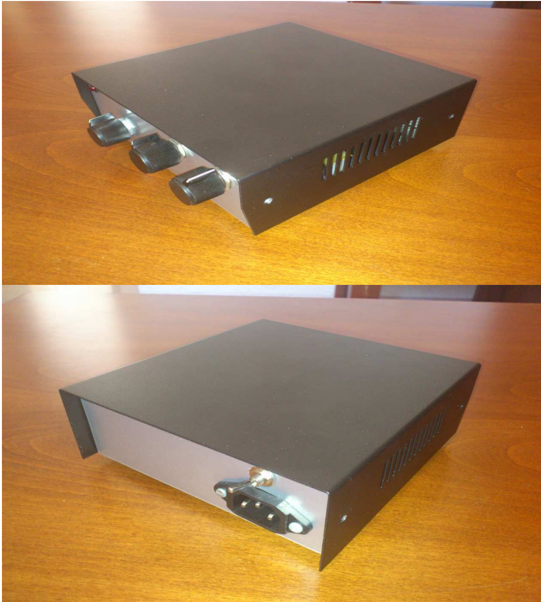
Εικόνα 18: Διακρίνεται το εξωτερικό κουτί του κυκλώματος και η είσοδος της τροφοδοσίας.
