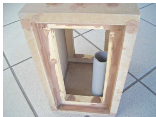
Σχήμα 6.42,3.Γίνεται στοκάρισμα σε όλο το ηχείο για να κλείσουν οι τρύπες
