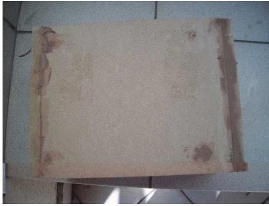
Σχήμα 6.44,45,46.Στα σχήματα αυτά βλέπουμε το στοκάρισμα του ηχείου πριν το βάνιμο.
