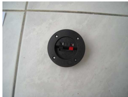
Σχήμα 6.41 Το τερματικό του ηχείου όπου συνδέονται οι ακροδέκτες από το crossover.
