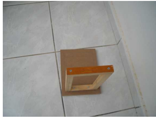
Σχήμα 6.16. Τοποθετήστε το επάνω μέρος της εσωτερικής βάσης.
