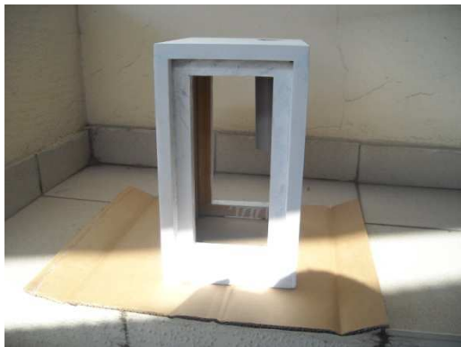
Σχήμα 6.47,48Περάστηκε ένα χέρι με βελατούρα για να βαφή ομοιόμορφα η καμπίνα.
