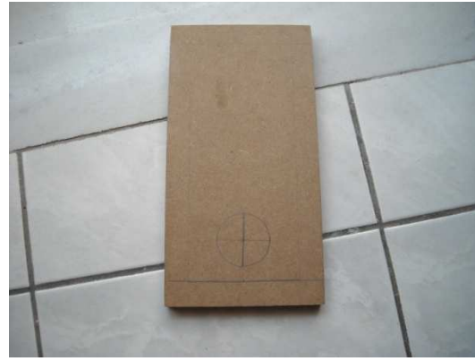
Σχήμα 6.39.Προετοιμασία για το άνοιγμα της πίσω τρύπας
