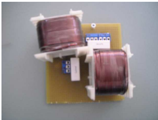
Σχήμα3.2 .Το crossover από την επάνω μεριά Σχήμα3.3. Το crossover από την κάτω μεριά κολλημένο με καλάι.
