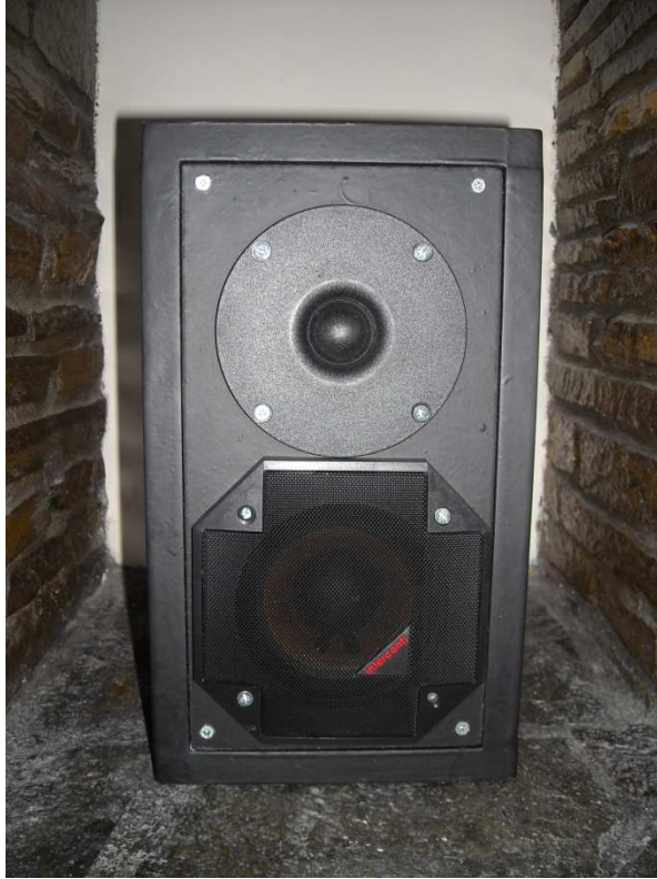
Σχήμα 6.49. Μετά το βάψιμο πήρε την παραπάνω μορφή και αφού τοποθετήθηκαν και τα μεγάφωνα επάνω του.
