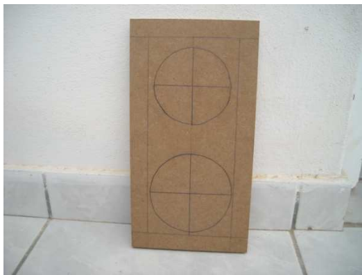
Σχήμα.6.5 Το μπροστινό κομμάτι έτοιμο για κόψιμο.
