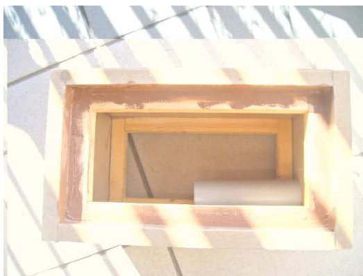
Σχήμα 6.42,3.Γίνεται στοκάρισμα σε όλο το ηχείο για να κλείσουν οι τρύπες
