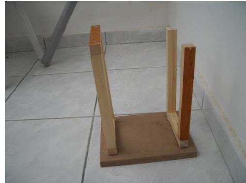
Σχήμα 6.18. Τοποθέτηση της δεύτερης βάσης πάλι με τον ίδιο τρόπο με κόλλα και ξυλόβιδες.
