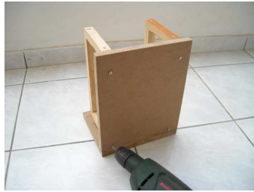
Σχήμα 6.22. Βίδωμα με ξυλόβιδες του πλευρικού μέρους.
