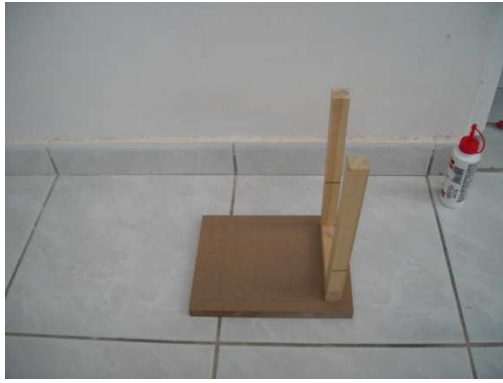
Σχήμα 6.15. Η πρώτη εσωτερική βάση τοποθετείται στην βάση της καμπίνα με κόλλα και με ξυλόβιδες.
