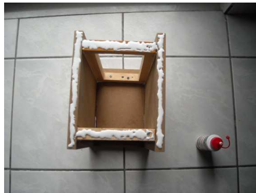
Σχήμα 6.30.Προετοιμασία για την κόλληση του πάνω μέρους της καμπίνας.
