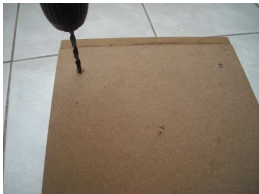
Σχήμα 6.36.Τρυπάμε για να μπουν οι βίδες πιο μέσα.
