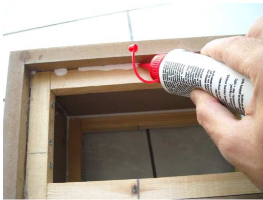
Σχήμα 6.35. Πέρασμα ολόκληρης της κατασκευής με κόλλα ώστε να κολλήσουν καλύτερα τα ξύλα με την εσωτερική βάση.
