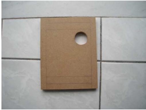
Σχήμα 6.9. Στο επάνω κομμάτι ανοίχτηκε η τρύπα για το bass reflex.
