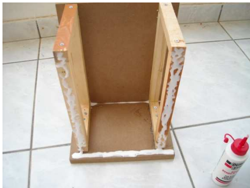
Σχήμα 6.23. Προετοιμασία με κόλλα για την τοποθέτηση του δεύτερου πλαϊνού μέρους.
