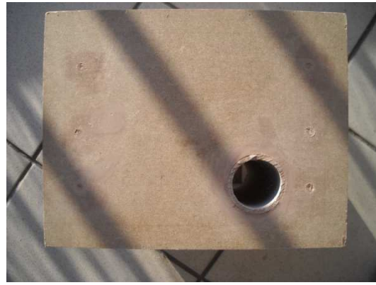
Σχήμα 6.44,45,46.Στα σχήματα αυτά βλέπουμε το στοκάρισμα του ηχείου πριν το βάνιμο.
