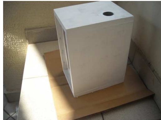
Σχήμα 6.47,48Περάστηκε ένα χέρι με βελατούρα για να βαφή ομοιόμορφα η καμπίνα.
