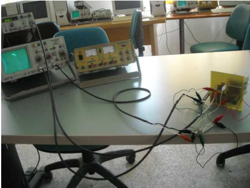
Σχήμα 3.5. Σύνδεση με την γεννήτρια ήχου και τον παλμογράφο.
