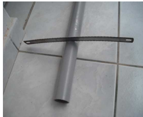
Σχήμα 6.26. Κόψιμο της σωλήνας στο μήκος που θέλουμε.
