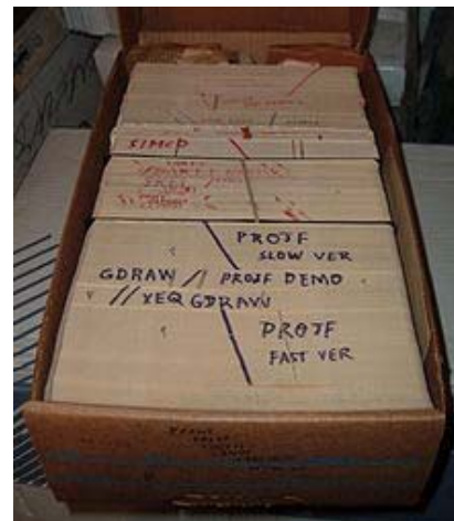
Εικ. 1.1. Στοιχεία και εντολές αποθηκεύονταν σε εξωτερικές διάτρητες κάρτες.
