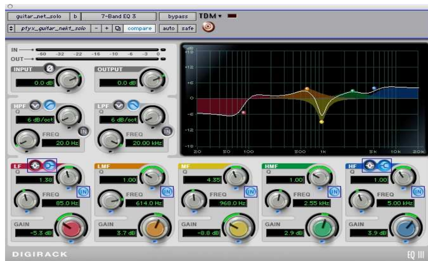
Εικόνα 4.16 Φίλτρο για το κανάλι της δεξιάς κιθάρας κατά τη διάρκεια του σόλου
