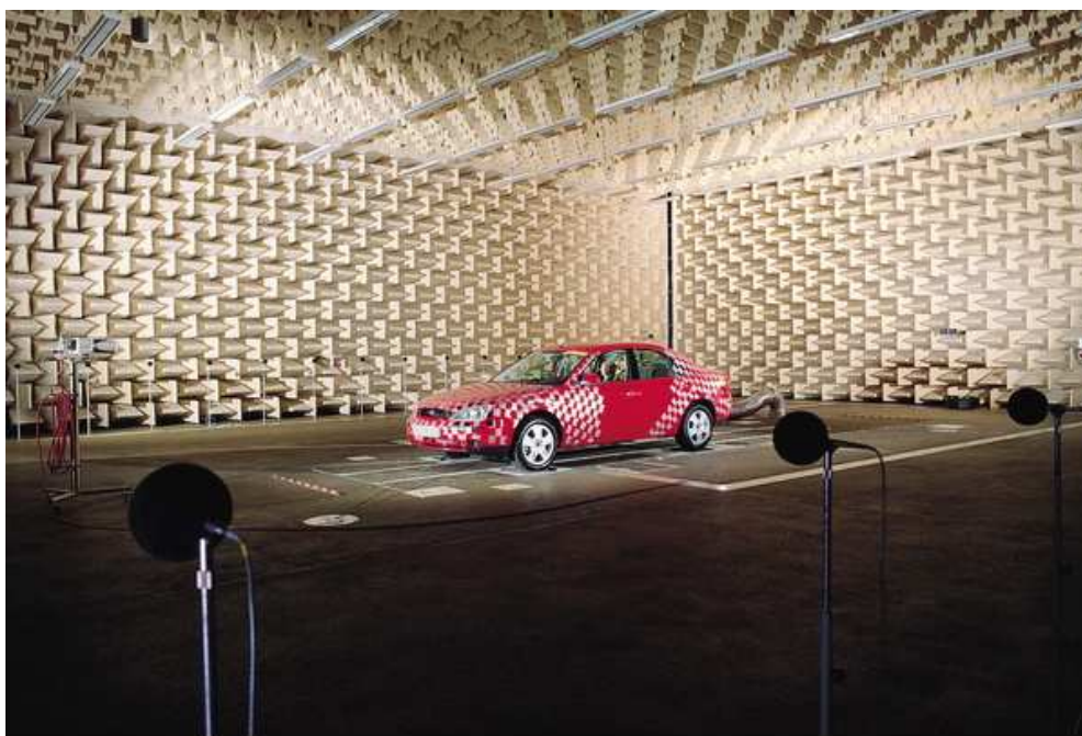
Εικόνα 3.1: Μέτρηση του εκπεμπόμενου θορύβου ενός οχήματος σε ειδικά διαμορφωμένο θάλαμο.
