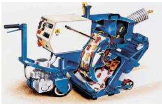
Εικόνα 3.7: Σχεδιάγραμμα της λειτουργίας του μηχανήματος.
