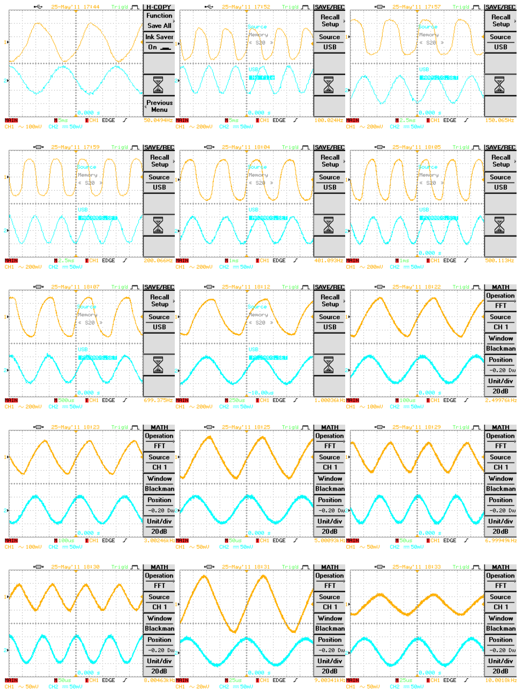
Σχήμα 32: Παραμόρφωση του σήματος για διάφορες συχνότητες με τη θέση του ποτενσιομέτρου “drive” στο maximum και “tone” στο “minimum”.
