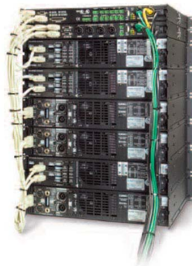
Σχήμα 6.34: Σύνδεση Data Port - άσπρα καλώδια. ( Http://www.qscaudio.com )
