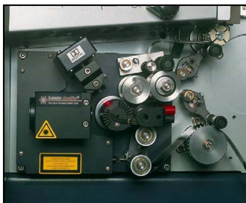
Σχήμα 3.4: Μαγνητική κεφαλή ανάγνωσης ηχητικής πληροφορίας, μέρος της κινηματογραφικής μηχανής προβολής.
