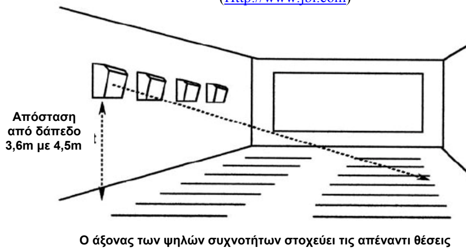
Σχήμα 6.8: Κλίση περιφερειακών ηχείων ( Http://www.jbl.com )
