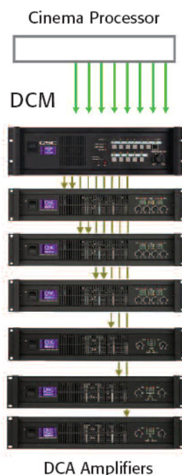
Σχήμα 6.33: Σύνδεση κινηματογραφικού επεξεργαστή με επεξεργαστή ψηφιακού σήματος και ενισχυτών QSC.
