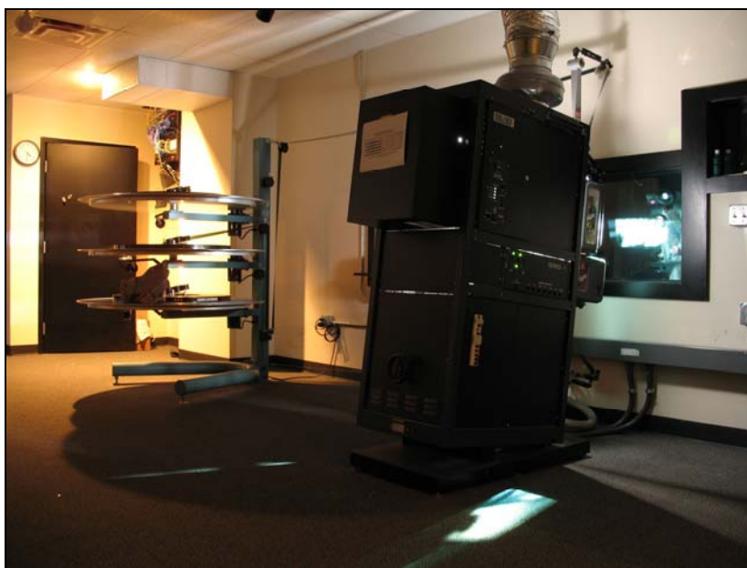
Σχήμα 4.5: Απομονωμένο δωμάτιο προβολής με τον προβολέα Century SA και την πιατέλα Cristie AW3 τύπου platter system.
