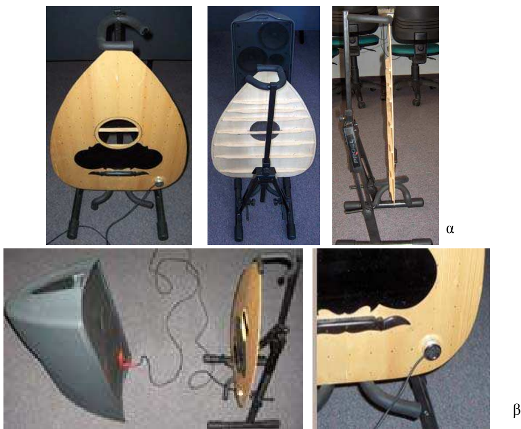
Εικόνα 4.2.1.1 Συνθήκες μέτρησης καπακιού λαούτου :
