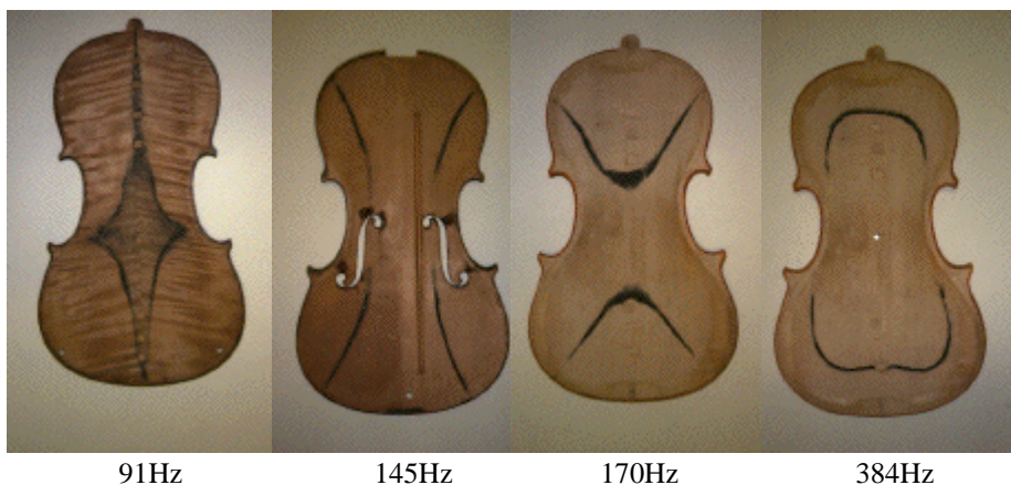
Εικόνα 1.2.2 Μοτίβα Chladni στο καπάκι και στην πλάτη ενός βιολιού [23].
