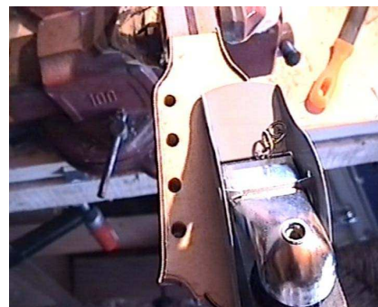
Εικ.3.9.34 κατεβάζουμε το ύψος των ξύλων ίσο με αυτό του λαιμού με την χρήση πλάνης χειρός.
