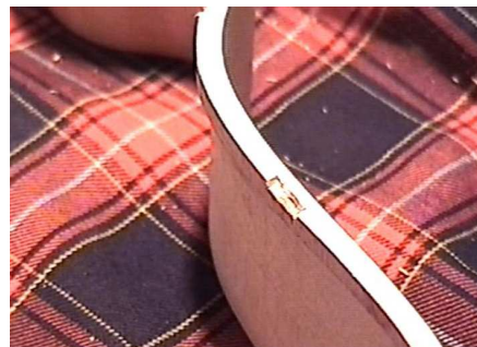
Εικ.3.7.10 αυλάκι που ανοίχτηκε στα υποστηρίγματα για την τοποθέτηση των νεύρων
