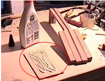
Εικ.3.9.22 στον κύκλο φαίνεται το κομμάτι ξύλου που θα κολληθεί στο κεφάλι του λαιμού.
