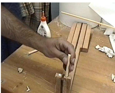
Εικ.3.9.43 Πιέζουμε τα ξύλα στην είσοδο της τρύπας, αφού έχουμε τοποθετήσει πρώτα κόλλα.
