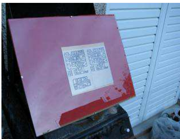
Εικόνα 31: Παράδειγμα τρόπου εκφώτισης της πλακέτας με την χρήση του ήλιου
