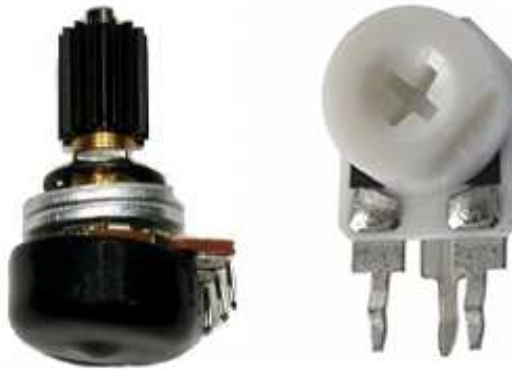
Εικόνα 37:Στα αριστερά το ποτενσιόμετρο ICAR και στα δεξιά το ποτενσιόμετρο trimpot.
