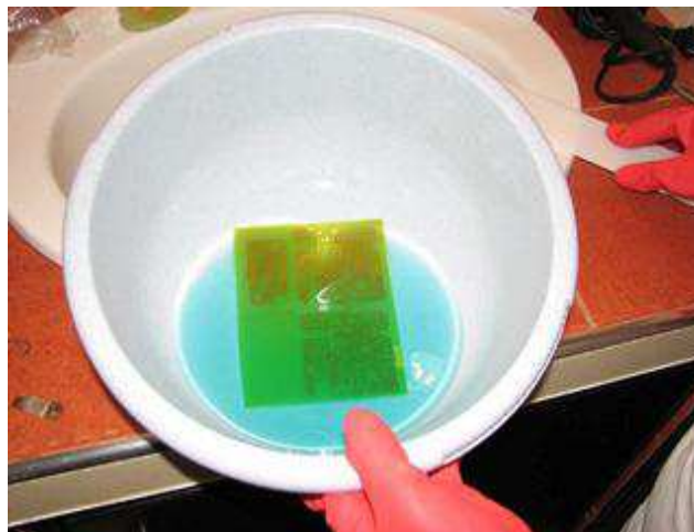
Εικόνα 32: Παράδειγμα διαδικασίας αποχάλκωσης.
