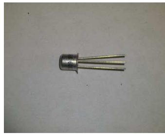
Εικόνα 25: Η όψη του τρανζίστορ BC109.
