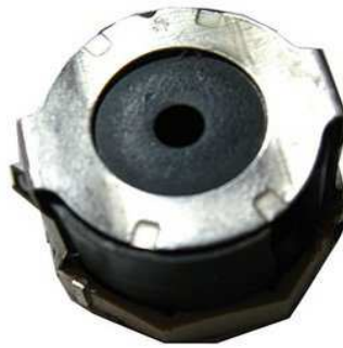
Εικόνα 26: Το χειροποίητο πηνίο της EyeRock (handmade inductor).
