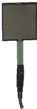
Εικόνα 34: Τύπος αισθητήρα fsg που χρησιμοποιήθηκε στην εφαρμογή.
