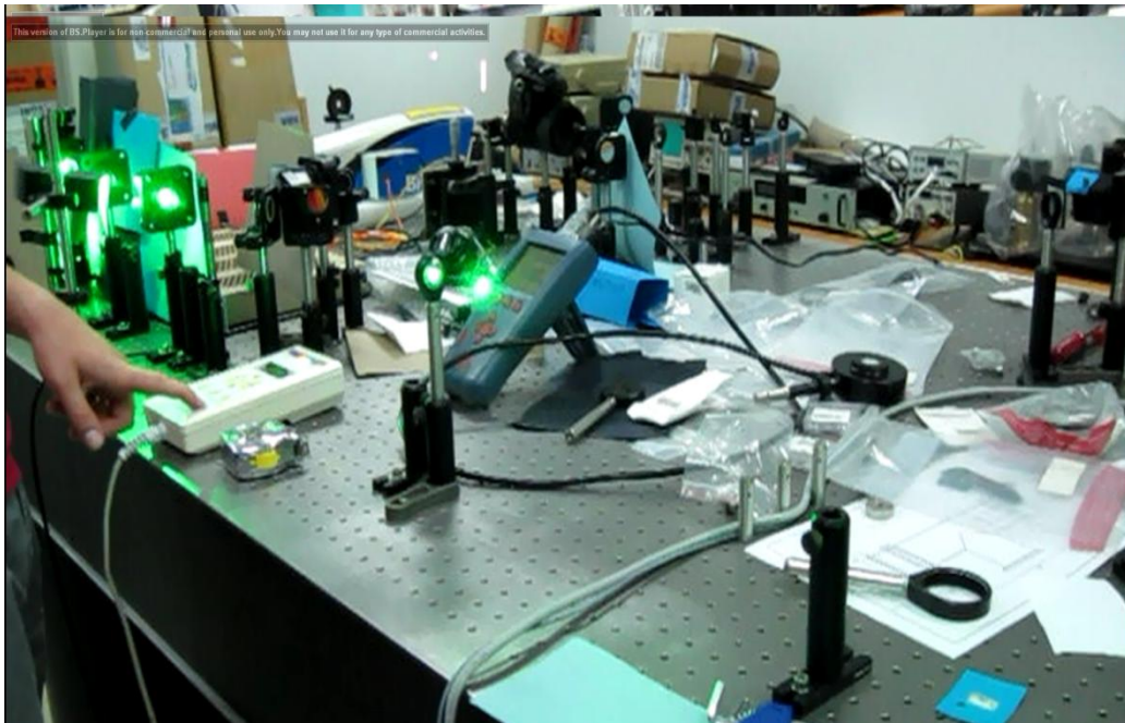
Εικόνα 9: Φωτογραφία της πειραματικής διάταξης που υλοποιήθηκε. Η εκκένωση φαίνεται (έντονο πράσινο χρώμα) σε απόσταση 5 cm μπροστά από τον φακό εστίασης.
