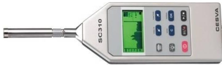
Εικόνα 7: Ηχόμετρο που χρησιμοποιήθηκε (SC310 της εταιρείας Cesva.
