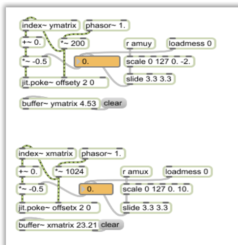
Εικόνα31: Η εγγραφή της συνάρτησης από το buffer~ στο jit.matrix (πάνω για των άξονα των frames, κάτω για των άξονα των συχνοτήτων).
