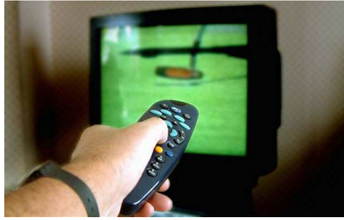
Σχήμα 1-5: Τυπική συσκευή με ενσωματωμένο υπέρυθρο (IR) δέκτη για τον απομακρυσμένο έλεγχο της λειτουργίας της.
