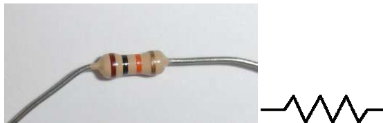
Σχήμα 2-5: Κυκλωματικό σύμβολο και ηλεκτρονικό στοιχείο αντιστάτης.
