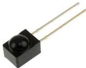
Σχήμα 2-12: Ηλεκτρονικό Στοιχείο Φωτοδιόδος BPV23F.
