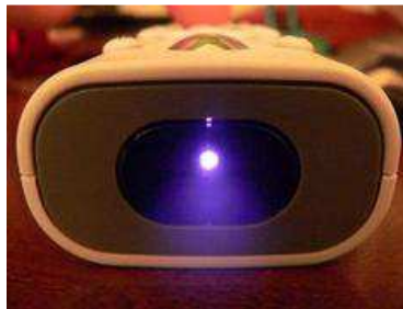
Σχήμα 1-3: Φωτοεκπομπός δίοδος LED να μεταδίδει υπέρυθρα σήματα από το τηλεχειριστήριο.
