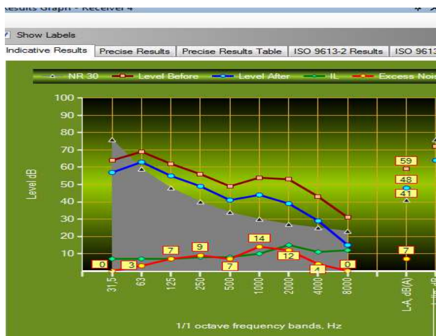
Σύγκριση 1.4: Πέτασμα I (υαλοβάμβακας), με απόσταση 15m από το δέκτη και ύψος 5m για το δέκτη 4.
