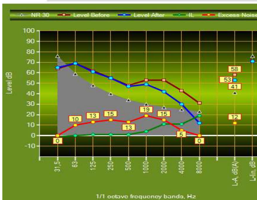
Σύγκριση 4.3: Πέτασμα Γ (υαλοβάμβακας), με απόσταση 15m από το δέκτη και ύψος 5m.
