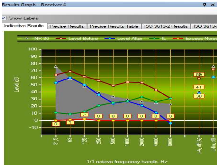
Σύγκριση 3.5: Πέτασμα Γ (glass wool), με απόσταση 10m από το δέκτη και ύψος 6m, για τους δέκτες 4 και 6.
