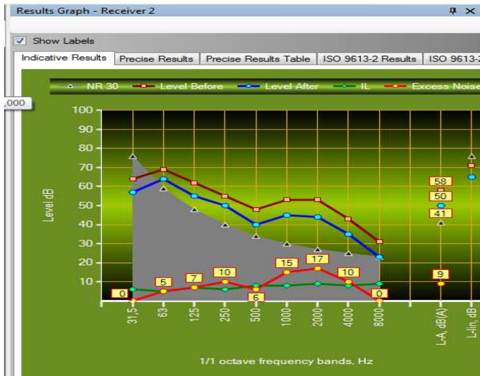
Σύγκριση 3.4: Πέτασμα Γ (υαλοβάμβακας), με απόσταση 10m από το δέκτη και ύψος 6m, για το δέκτη 2.
