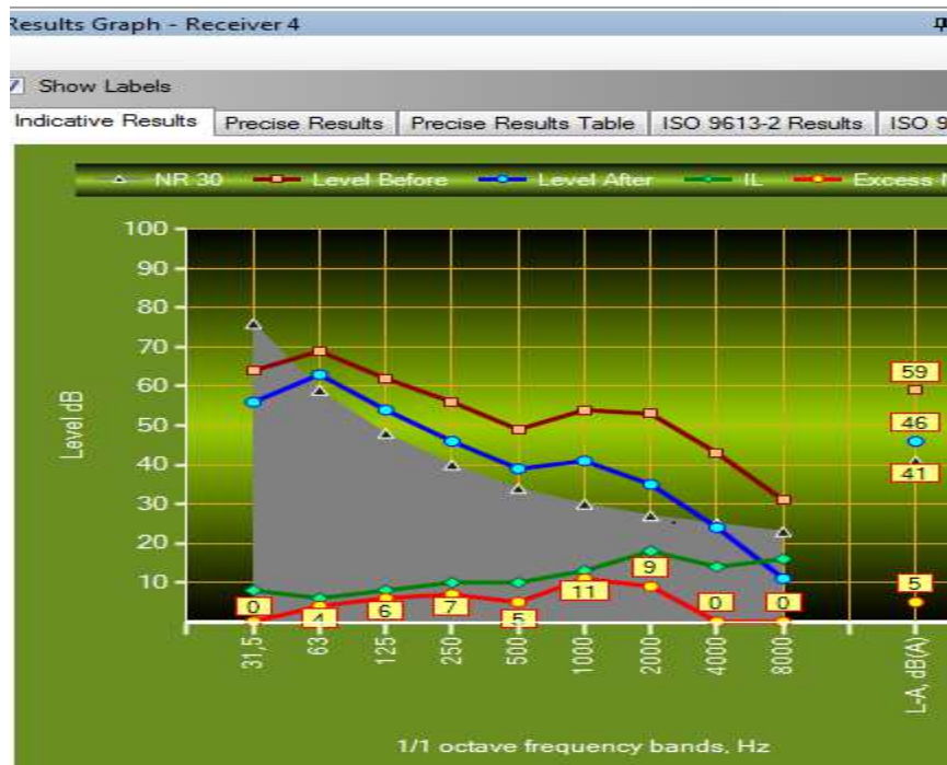
Σύγκριση 2.4: Πέτασμα I (υαλοβάμβακας), αμελητέου πάχους, με απόσταση 10m από το δέκτη και ύψος 5m, για τους δέκτες 4 και 6.
