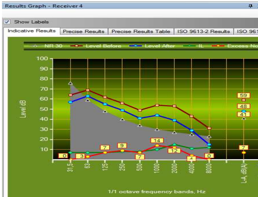
Σύγκριση 4.1: Πέτασμα I (υαλοβάμβακας), με απόσταση 15m από το δέκτη και ύψος 5m.
