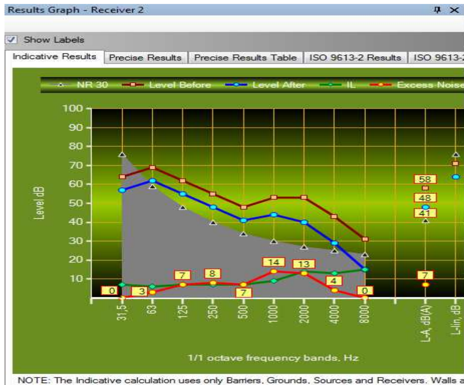
Σύγκριση 1.3: Πέτασμα I (υαλοβάμβακας), με απόσταση 15m από το δέκτη και ύψος 5m για το δέκτη 2.
