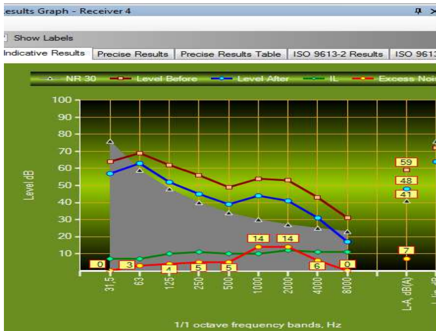
Σύγκριση 2.2: Πέτασμα I (υαλοβάμβακας), μη αμελητέου πάχους, με απόσταση 10m από το δέκτη και ύψος 5m, για τους δέκτες 4 και 6.
