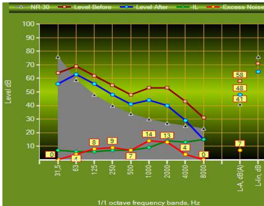
Σύγκριση 4.4: πέτασμα WEDGE (υαλοβάμβακας), με απόσταση 15m από το δέκτη και ύψος 5m.
