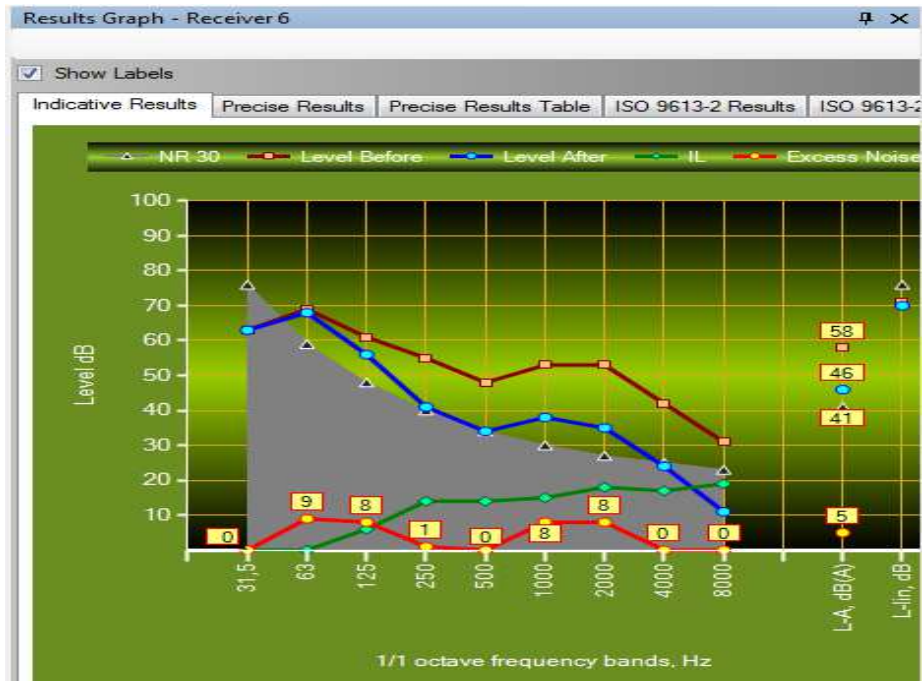
Σύγκριση 3.3: Πέτασμα Γ (υαλοβάμβακας), με απόσταση 10m από το δέκτη και ύψος 5m, για το δέκτη 6.
