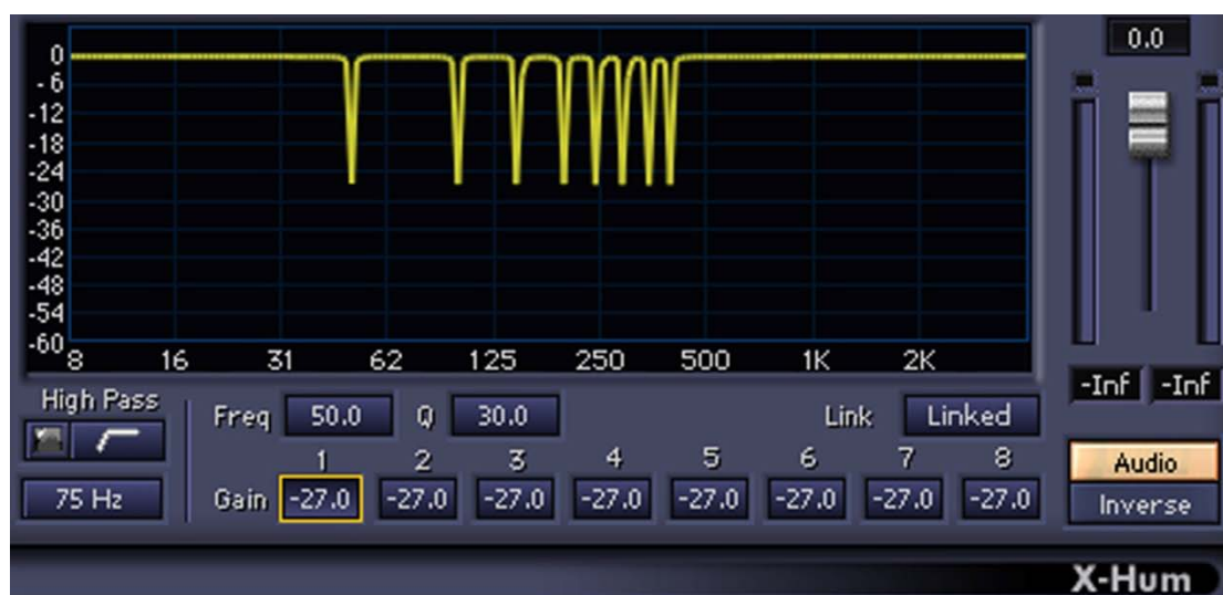
Εικόνα 13.2.2: Με φίλτρο τύπου "χτένας", το plug-in X-Hum της εταιρείας Waves, αφαιρέθηκε ο ήχος που προκλήθηκε από το βρόχο γείωσης.
