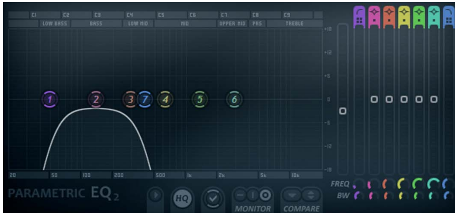
Εικόνα 14.2.4: Το φίλτρο διέλευσης ζώνης, επιτρέπει τη διέλευση συχνοτήτων, μόνο στην χαμηλή και χαμηλο-μεσαία συχνοτική περιοχή.
