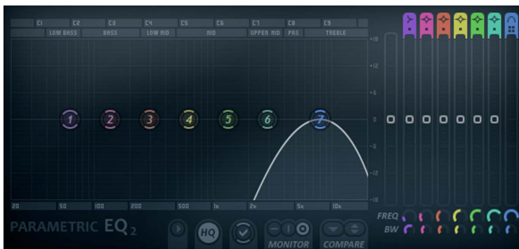
Εικόνα 10.3.2: Το φίλτρο διέλευσης ζώνης, επιτρέπει να περάσουν μόνο οι μεσαίο-υψηλές και υψηλές συχνότητες.
