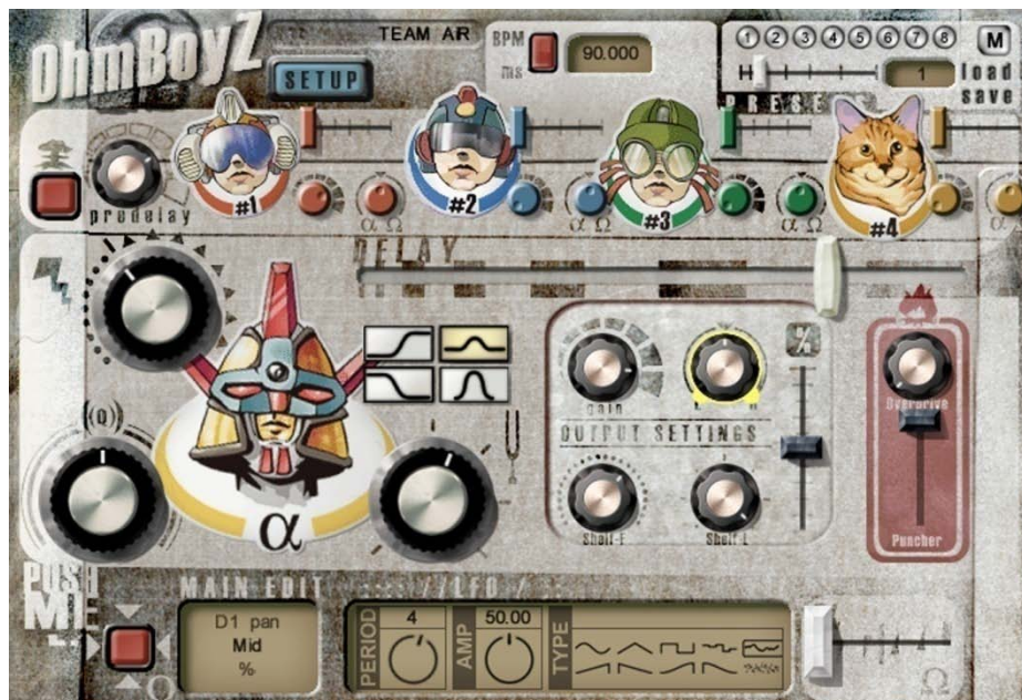
Εικόνα 7.3.2: OhmBoyz, Filter delay εφέ με δυνατότητα αυτοματισμού σε οποιαδήποτε παράμετρο.
