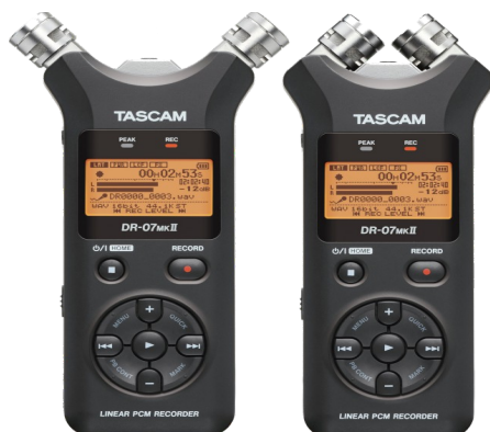
Εικόνα 4.1.1 PCM Recorder. Αριστερά η AB γωνία λήψης και δεξιά η XY.
